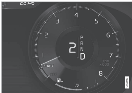
Pantalla del conductor al cambiar de marcha con las levas del volante.
