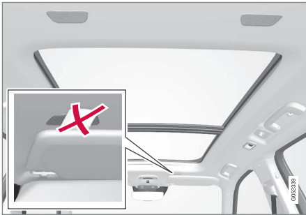
Micrófonos en el techo del vehículo.
