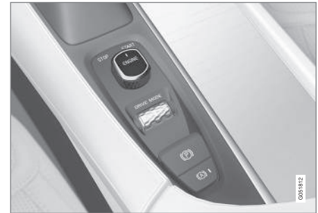
Control de arranque en la consola del túnel.
