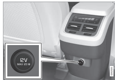
Toma de 12 V en la consola del túnel, segunda fila de asientos.
