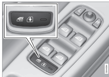
Pannello di comando nella portiera del conducente.
