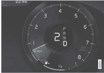
شاشة السائق عند تغيير التروس باستخدام محركات عجلة القيادة.
