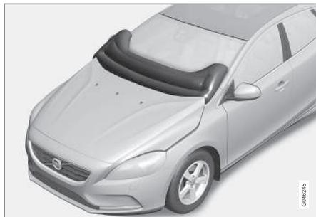
Ce coussin gonflable pour piéton (Pedestrian Airbag) est monté sous le capot moteur, au pied du pare-brise. Dans certaines collisions frontales avec un piéton, les capteurs du pare-chocs avant réagissent et le coussin gonflable est gonflé si la violence de la collision est jugée suffisamment importante. Les capteurs sont actifs à une vitesse d'environ 20 à 50 km/h (12-30 mph) et à une température ambiante comprise entre -20 et +70 °C.
