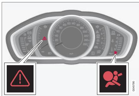
Triangle de pré-signalisation ainsi que témoin d'avertissement pour système d'airbag (p. 34) dans le combiné d'instruments analogique.
