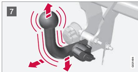
7 Contrôlez que la boule est bien fixée en la frappant vers le haut, le bas et l'arrière.
