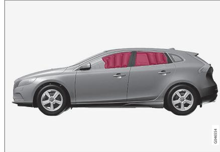
Le rideau gonflable IC (Inflatable Curtain) est un composant du système SIPS (p. 39). Il est dissimulé dans la garniture de plafond des deux côtés de la voiture et il protège le conducteur et les occupants des places extérieures. Lors d'une forte collision, les capteurs réagissent et le rideau gonflable se gonfle.
