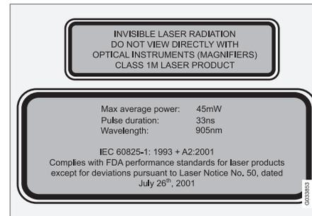
L'autocollant supérieur de l'illustration décrit la classification du faisceau laser :
