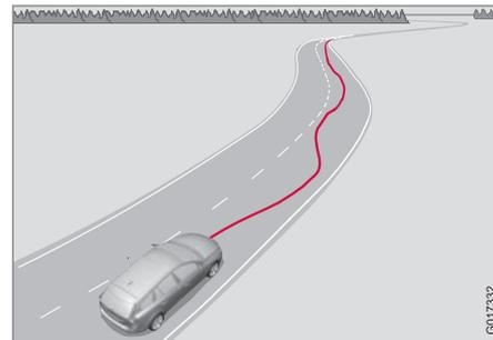
Une caméra détecte le marquage au sol et compare son tracé aux mouvements du volant. Le conducteur est averti lorsque le véhicule ne suit pas la chaussée de façon régulière.
