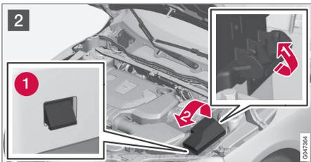
2 1 Ouvrez le verrou situé sur le côté de la centrale électrique.
