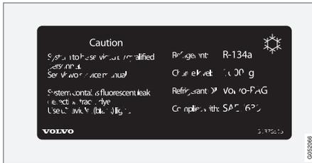
L'autocollant est collé sur la face intérieure du capot moteur.
