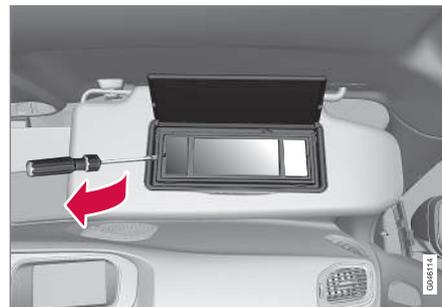
1. Insérez un tournevis sous la lentille et faites lever avec précaution sur la patte, sur le bord.
