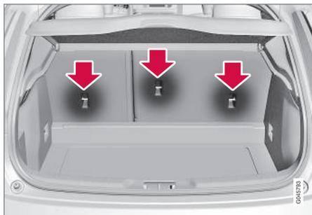
Les points de fixation supérieurs sont principalement conçus pour être utilisés avec des sièges enfants face à la route. Volvo recommande que les enfants en bas âge soient assis dans un siège enfant dos à la route aussi longtemps qu'il est possible.
