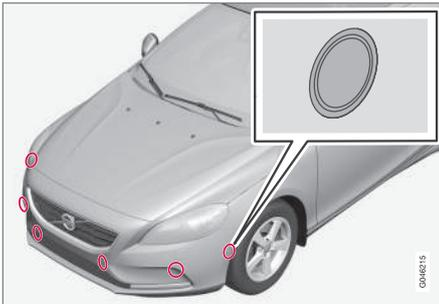
Les capteurs PAP se trouvent dans les pare-chocs<sup>37</sup> : 6 à l'avant et 4 à l'arrière.
