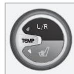
La température peut être réglée séparément du côté conducteur et du côté passager. Appuyez plusieurs fois sur le bouton **L/R** pour sélectionner le côté gauche, le côté droit ou les deux.
