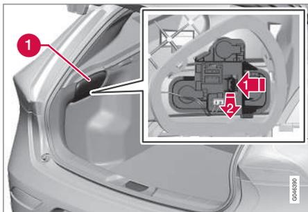
1. Retirez la trappe dans la garniture (1) du côté de l'ampoule défectueuse.
