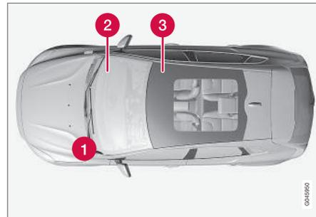
Emplacement des centrales sur une voiture avec conduite à gauche. Pour les voitures avec conduite à droite, la centrale se trouve du côté de la boîte à gants.
