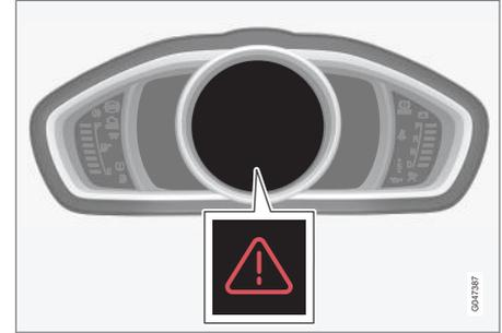
*Triangle de pré-signalisation sur le combiné d'instruments numérique.*
