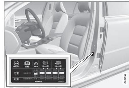
L'autocollant de pressions de pneu sur le montant de porte du côté conducteur (entre la porte avant et la porte arrière) indique quelle pression les pneus doivent avoir à différentes conditions de charge et de vitesse. La pression correcte est aussi indiquée dans le tableau de pressions de pneu.
