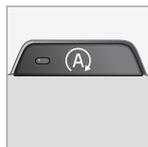
La fonction Start/Stop est automatiquement activée lors du démarrage du moteur. Le conducteur est informé que la fonction est active grâce au symbole du bouton Marche/Arrêt sur le combiné d'instruments et au témoin du bouton Marche/Arrêt allumé.
