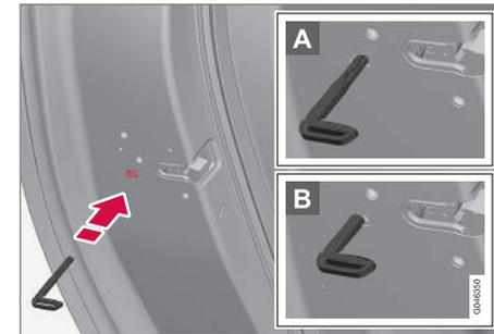
Verrouillage manuel d'une porte. À ne pas confondre avec le Verrouillage de sécurité enfant (p. 183).
