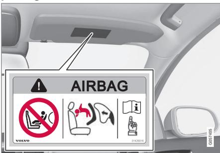
Autocollant sur le pare-soleil du côté passager.
