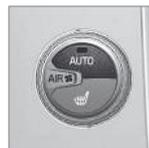
Tournez le bouton de réglage pour augmenter ou réduire la vitesse du ventilateur, le mode **AUTO** est désactivé. Si **AUTO** est sélectionné la vitesse du ventilateur est régulée automatiquement (p. 138) - le réglage de la vitesse du ventilateur est annulé.
