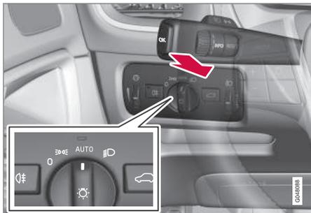
Levier au volant et bouton du commutateur d'éclairage en position **AUTO**.
