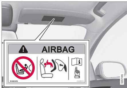
Autocollant sur le pare-soleil du côté passager.
