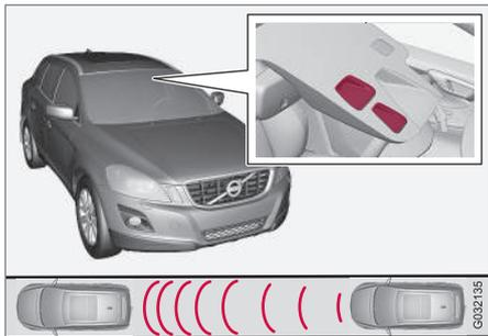
Fenêtre d'émission et de réception du capteur laser<sup>18</sup>.
