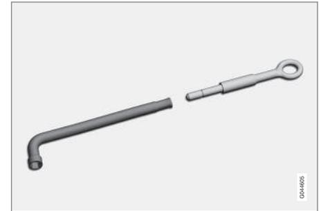
Clé à écrou de roue et œillet de remorquage.
