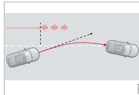
*LKA intervient et avertit le conducteur par des vibrations au volant<sup>28</sup>.*
