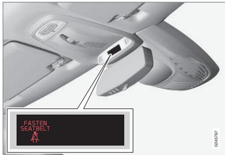
Le rappel sonore dépend de la vitesse et parfois du temps. Le rappel lumineux est situé dans la console du plafond et dans le combiné d'instruments (p. 65).
