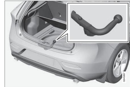
Lorsqu'il n'est pas utilisé, le crochet d'attelage amovible doit être rangé dans le bloc de mousse<sup>17</sup> sous le plancher du compartiment à bagages.
