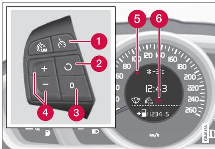
Clavier au volant et écran dans une voiture avec limiteur de vitesse<sup>5</sup>.
