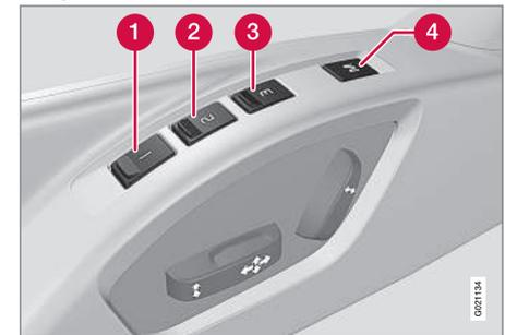
La fonction mémoire enregistre les paramètres du siège et des rétroviseurs extérieurs.
