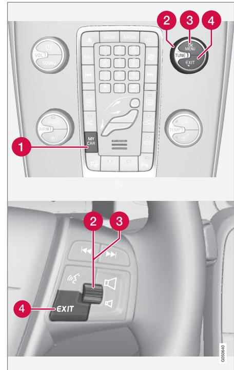
Panneau de commande de la console centrale et commandes au volant. L'illustration est simplifiée, le nombre de fonctions et le placement des
