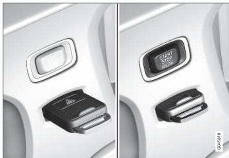
Contacteur d'allumage avec télécommande retirée/insérée.
