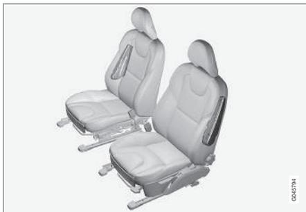
Le système SIPS se compose de deux parties principales : des coussins gonflables latéraux et des capteurs. Les coussins gonflables latéraux sont intégrés dans les cadres des dossiers des sièges avant.
