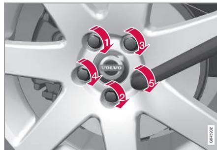
4. Serrez fermement les écrous de roue en croix et de manière alternée. Il est important que les écrous de roue soient bien serrés au couple de serrage correct. Vérifiez le couple de serrage des écrous à l'aide d'une clé dynamométrique.
