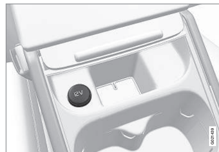
12 V-uttak i tunnellkonsoll, forsete.
