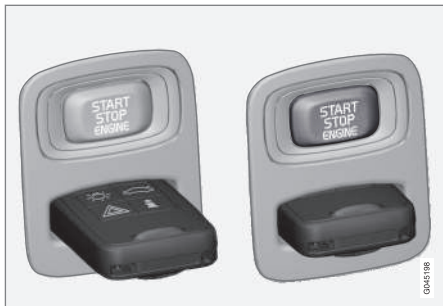
Contactsloot met transpondersleutel uitgetrokken/ingeduwd.
