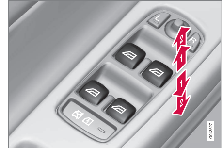
Bedieningsknoppen elektrisch bediende zijruiten.
