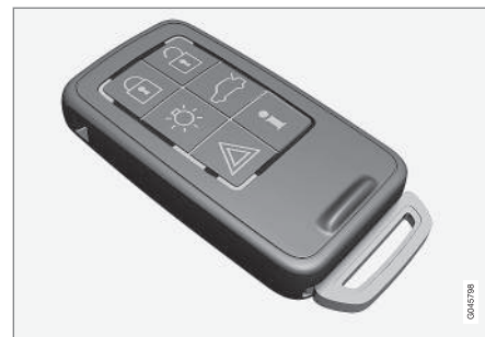
Transpondersleutel met PCC*( Personal Car Communicator).
