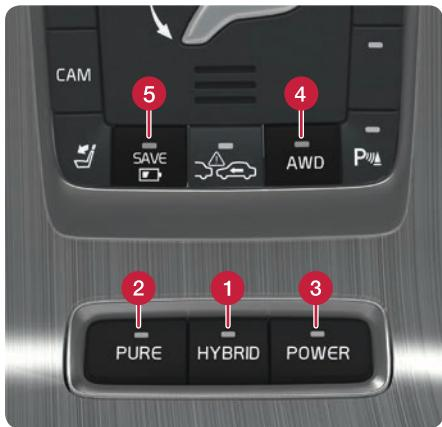
La voiture est équipée d'une motorisation hybride - électrique et diesel. Vous pouvez sélectionner différents modes de conduite. Il n'est pas possible de choisir un « mauvais » mode de conduite - la voiture revient en mode HYBRID si certaines conditions ne sont pas remplies. Le témoin du bouton hybride s'allume alors.
