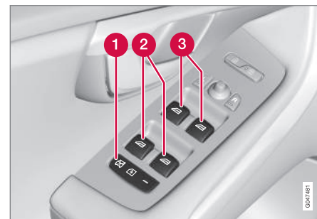
Panneau de commande de la porte conducteur.
