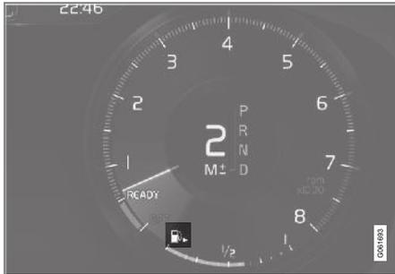
Der beigefarbene Bereich der Tankanzeige entspricht der im Tank befindlichen Kraftstoffmenge.
