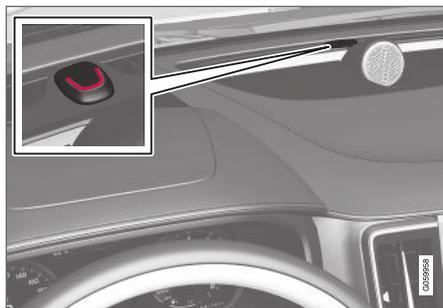
Wenn das Fahrzeug verriegelt und die Alarmanlage aktiviert ist, blinkt eine rote LED am Armaturenbrett alle zwei Sekunden auf.
