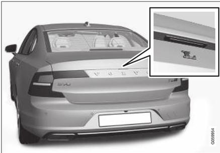
Der Kofferraumdeckel wird von einem elektrischen Schloss geschlossen gehalten.
