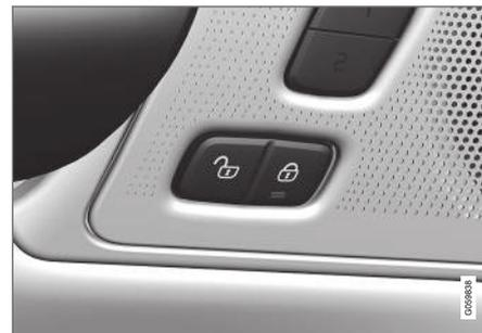
Verriegelungstasten mit Anzeigeleuchte an der Vordertür.
