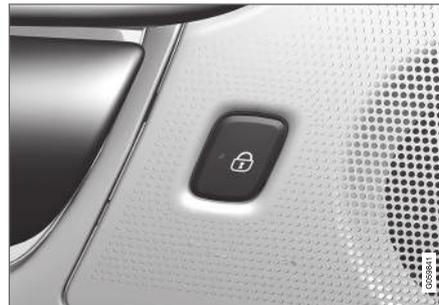
Verriegelungstaste mit Anzeigeleuchte an der Hintertür.
