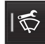
Tippen Sie auf **Wartungsposition Wischer**. Bei aktivierter Wartungsstellung leuchtet die Anzeigeleuchte der Taste. Bei der Aktivierung werden die Scheibenwischer in die Wartungsstellung gebracht.
