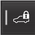
Die Taste für die Privatverriegelung (Private Locking) befindet sich in der Ansicht Funktionen auf dem Center Display. Je nach aktuellem Verriegelungsstatus wird **Private Locking entsperrt** oder **Private**
