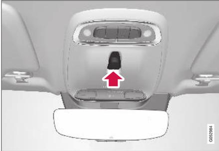
Das Schiebedach wird mit einem Regler an der Decke bedient. Der Regler kann bedient werden, wenn die Fahrzeugelektrik in Zündstellung I oder II steht.
