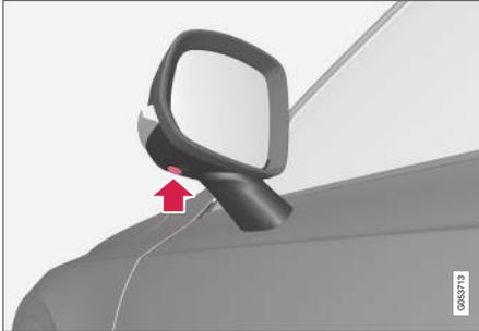
Die Seitenkameras befinden sich in den Seitenspiegeln.
