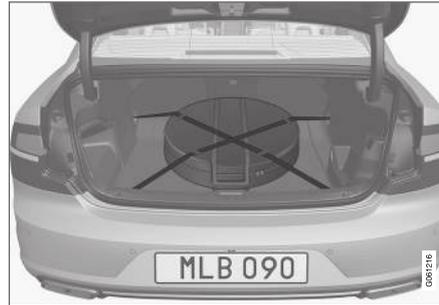
Das Reserverad wird in einer Tasche aufbewahrt und muss während der Fahrt mit zwei Riemen am Boden des Koffer-/Laderaums festgespannt sein. Die Riemen über dem Rad müssen über Kreuz gespannt werden und sind in den vier Lastsicherungsösen des Fahrzeugs zu verankern.
