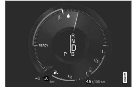
Fahrerdisplay bei Antrieb durch Elektro- und Verbrennungsmotor.
