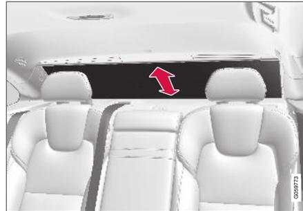
Eine elektrisch betätigte Sonnenblende ist in die Ablage der Heckscheibe eingebaut.
