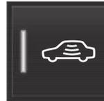
Tippen Sie in der Ansicht Funktionen des Center Displays auf **Verminderter Schutz**, um die Bewegungs- und Neigungssensoren beim nächsten Verriegeln des Fahrzeugs zu deaktivieren.
