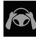
Wenn Pilot Assist feststellt, dass nicht beide Hände am Lenkrad sind, wird der Fahrer nach einem Moment mit einem Symbol und einer Textmeldung aufgefordert, das Fahrzeug aktiv zu lenken.
