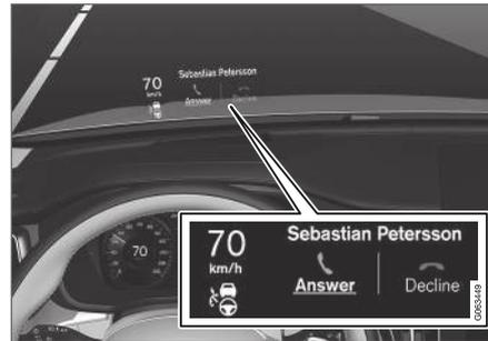
Auf dem Head-up-Display werden Warnungen und Informationen zu Geschwindigkeit, Tempomatfunktionen, Navigation usw. direkt in das Sichtfeld des Fahrers eingeblendet. Auch Verkehrsschildinformationen und eingehende Anrufe können auf dem Head-up-Display angezeigt werden.
