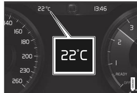
Nach einem Stillstand des Fahrzeugs kann die Anzeige eine zu hohe Temperatur anzeigen.
