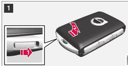
**1** Halten Sie den Transponderschlüssel so, dass die Vorderseite nach oben weist und das Volvo-Emblem richtig ausgerichtet liegt. Schieben Sie den Schalter beim Schlüsselring am unteren Rand nach rechts. Schieben Sie die Abdeckung der Vorderseite einige Millimeter nach oben.
