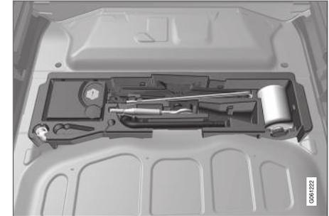
Im Schaumblock unter dem Kofferraumboden befinden sich die Abschleppöse, das Reifenpannen-Set, das Werkzeug zum Entfernen der Plasticaufsätze an den Radmuttern und der Steckaufsatz für die abschließbaren Radmuttern.
