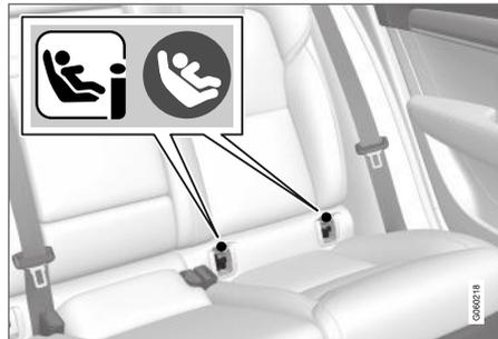
Sie erkennen die Befestigungspunkte an den Symbolen<sup>2</sup> hinten an der Rückenlehne.
