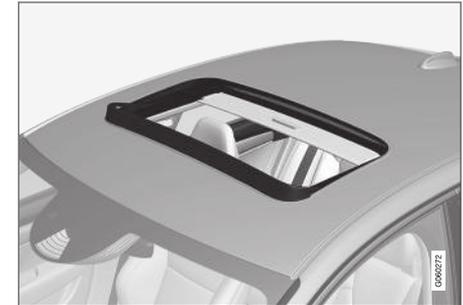
Zum Schiebedach gehört ein Windabweiser, der bei geöffnetem Schiebedach hochgeklappt wird.
