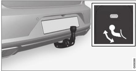
Führen Sie die Anhängerkupplung in ihre Endstellung und lassen Sie sie einrasten – die Anzeigeleuchte leuchtet konstant orange.
