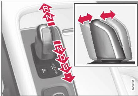
Sie wechseln die Schaltstellung, indem Sie den gefederten Wählhebel nach vorn oder hinten drücken.
