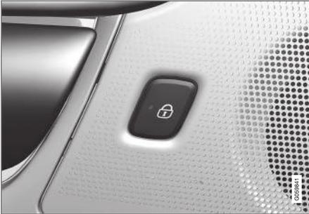
Verriegelungstaste mit Anzeigeluchte an der Fondtür.
