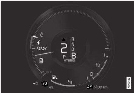
Das Fahrzeug erzeugt Strom für die Batterie, die aufgeladen wird, z. B. bei einem leichten Druck auf das
