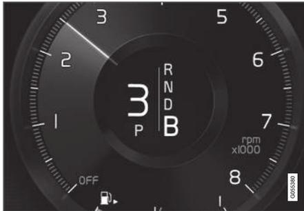
Aus der Stellung **B** kann manuell in niedrigere Gangstellungen heruntergeschaltet werden. Die Stellung **B** kann während der Fahrt jederzeit ausgewählt werden. Wenn das Gaspedal losgelassen wird, wird die Elektromotorbremse des Fahrzeugs aktiv und gleichzeitig die Hybridbatterie aufgeladen. Dadurch wird die Hybridbatterie auch dann aufgeladen, wenn der Fahrer das Bremspedal nicht betätigt.
