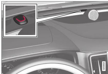
Die Verriegelungs- und Alarmanzeige zeigt den Status des Verriegelungssystems an:
