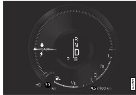
Die Hybridanzeige stellt in unterschiedlicher Weise das Verhältnis zwischen bereits aus dem Elektromotor entnommener und noch verfügbarer Leistung dar.
