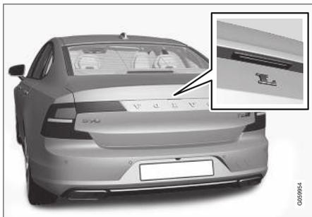
Die gummierte Druckplatte am Griff des Kofferraumdeckels dient ausschließlich der Entriegelung.
