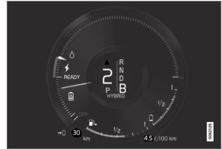
Wenn beim Einsatz der elektromotorischen Bremse ein Aufladen erfolgt, wird dies auf dem Fahrerdisplay angezeigt.
