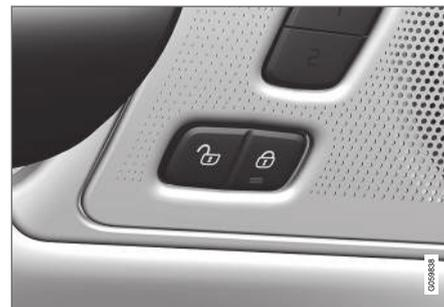
Ver- und Entriegelungstaste mit Anzeileuchte an der Vordertür.
