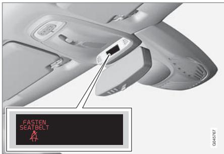
เสียงเตือนจะขึ้นอยู่ด้วยความเร็วและในบางกรณีจะขึ้นอยู่ กับเวลา สัญญาณเตือนจะแสดงอยู่ในคอนโซลบริเวณ หลังคาและในแผงหน้าปัดแบบรวม (น. 78)
