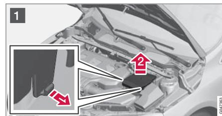
1 **1** ▶ พับสลักล๊อคที่ติดตั้งไว้ที่ด้านข้างของฝาครอบบนแบตเตอรี่สตาร์ทออก
