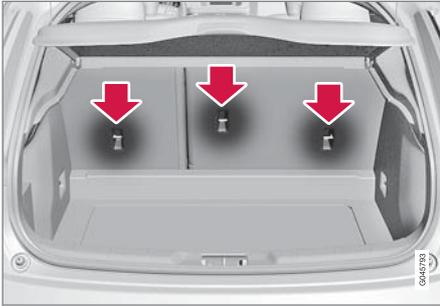
จุดยึดด้านบนจะใช้สำหรับเบาะนั่งสำหรับเด็กแบบหันไปข้างหน้าเป็นหลัก สำหรับเด็กเล็ก วอลโว่ขอแนะนำให้ใช้เบาะนั่งสำหรับเด็กแบบหันหน้าไปข้างหน้าให้นานที่สุดเท่าที่จะเป็นไปได้
