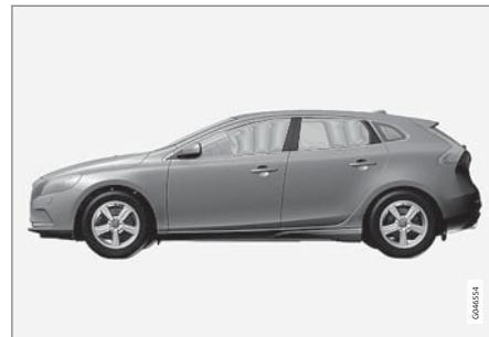
ม่านนิรภัยกันกระแทก IC (Inflatable Curtain) เป็นส่วนหนึ่งของระบบ SIPS (น. 43) โดยจะติดตั้งอยู่ตามแนวยาวทั้งสองด้านของแผงบุหลังคา และช่วยปกป้องคนขับและผู้โดยสารที่นั่งอยู่บนที่นั่งตัวนอก เมื่อเกิดการชนที่รุนแรงพอ เซ็นเซอร์ต่างๆ จะตอบสนอง และม่านนิรภัยกันกระแทกจะพองตัว
