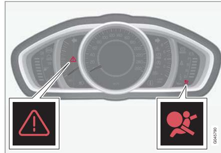
สัญลักษณ์เตือนรูปสามเหลี่ยมและสัญลักษณ์เตือนสำหรับระบบถุงลมนิรภัย (น. 37) ในแผงหน้าปัดแบบรวมแบบอนาล็อก
