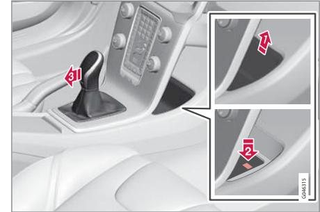
หากไม่สามารถขับรถได้ เช่น เนื่องจากแบตเตอรี่ไฟหมด จะต้องเลื่อนคั่นเลือกเกียร์ออกจากตำแหน่ง P เพื่อให้สามารถเคลื่อนรถได้
