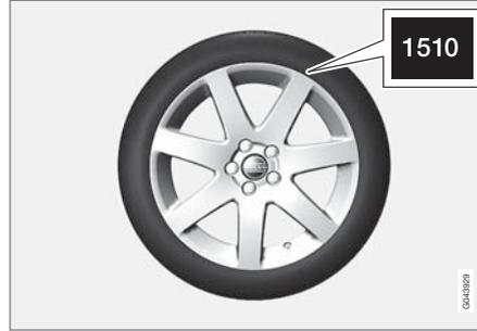
ยางเป็นวัสดุที่เสื่อมสภาพได้ หลังจากสองสามปี ยางจะเริ่มแข็งขึ้นพร้อมกับที่ความสามารถ/คุณสมบัติด้านแรงเสียดทานจะค่อยๆ ลดลง ด้วยเหตุนี้เมื่อเปลี่ยนยาง ควรเลือกยางที่ใหม่ที่สุดเท่าที่จะเป็นไปได้ โดยเฉพาะถ้าเป็นยางสำหรับฤดูหนาวจะเป็นสิ่งสำคัญอย่างยิ่ง ตัวเลขสี่ตัวสุดท้ายหมายถึงสัปดาห์และปีที่ผลิต เครื่องหมาย DOT Department of Transportation ของยางจะระบุได้ด้วยตัวเลขสี่หลัก ตัวอย่างเช่น 1510 ยางที่แสดงในภาพประกอบได้ผลิตขึ้นในสัปดาห์ที่ 15 ของปี 2010
