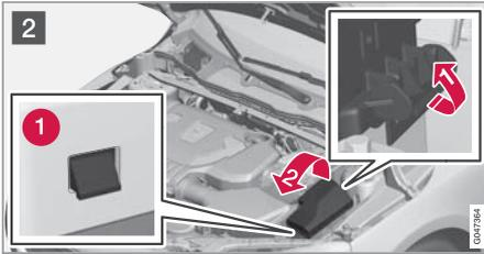
2 **1** ▶ พับสลักล๊อคที่ติดตั้งอยู่ที่ด้านข้างของชุดกล่องต่อไฟออก
