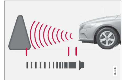
ระยะที่ครอบคลุมถึงทางด้านหน้าของรถคือ ประมาณ 0.8 เมตร สัญญาณเสียงสำหรับสิ่งกีดขวางด้านหน้าจะมาจากลำโพงตัวใดตัวหนึ่งที่อยู่ด้านหน้า
