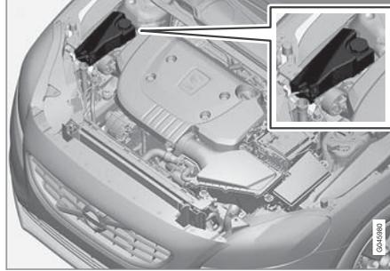
เมื่อเติมน้ำหล่อเย็น ให้ปฏิบัติตามคำแนะนำบนบรรจุภัณฑ์ อย่าเติมน้ำเปล่าเพียงอย่างเดียว ความเสี่ยงในการที่น้ำจะแข็งตัวอาจเพิ่มขึ้น ถ้าความเข้มข้นของน้ำหล่อเย็นมากหรือน้อยเกินไป
