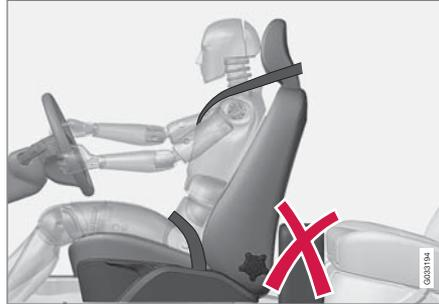
ห้ามวางวัตถุใดๆ ไว้บนพื้นด้านหลังที่นั่งคนขับหรือที่นั่งผู้โดยสารที่อาจกีดขวางไม่ให้ระบบ WHIPS ทำงาน
