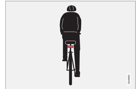
ตัวอย่างที่ดีที่สุดของสิ่งที่จะระบบแปลความหมายว่าเป็นคนขี่รถจักรยาน คือ มีเส้นโครงร่างของลำตัวและรถจักรยานอย่าง
