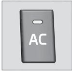
เมื่อไฟแสดงในปุ่ม AC สว่าง ระบบปรับอากาศถูกควบคุมโดยการทำงานอัตโนมัติของระบบ
