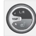
อุณหภูมิด้านคนขับและด้านผู้โดยสารสามารถตั้งได้แยกกัน กด L/R ในปุ่มซ้ายๆ เพื่อเลือกการตั้งค่าสำหรับฝ่ายซ้าย, ด้านขวา หรือทั้งสองด้าน ตั้งอุณหภูมิโดยใช้ปุ่มหมุน
