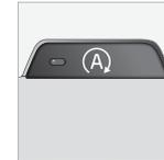
Start/Stop จะทำงานโดยอัตโนมัติเมื่อท่านสตาร์ทรถด้วยกุญแจ คนขับจะได้รับการแจ้งให้ทราบเกี่ยวกับฟังก์ชันนี้ โดยสัญลักษณ์สำหรับปุ่ม เปิด/ปิด จะติดสว่างขึ้นในแผงหน้าปัดแบบรวม และไฟในปุ่ม เปิด/ปิด ก็ จะติดสว่างขึ้นด้วย
