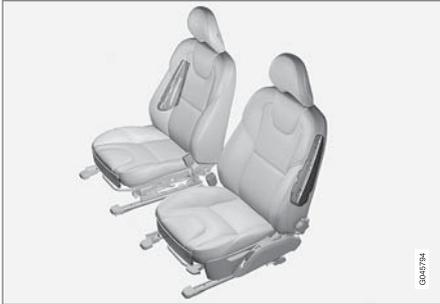
ระบบถุงลมนิรภัย SIPS ประกอบด้วยส่วนประกอบสำคัญสองส่วน คือ ถุงลมนิรภัยด้านข้างและเซ็นเซอร์ต่างๆ ถุงลมนิรภัยด้านข้างจะติดตั้งไว้ในพนักพิงของที่นั่งด้านหน้า
