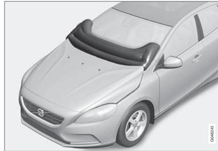
ถุงลมนิรภัยสำหรับคนเดินถนน Pedestrian Airbag ติดตั้งอยู่ใต้ฝากระโปรงหน้าบริเวณใกล้กับกระจกหน้า ในกรณีที่เกิดการชนคนเดินถนนด้านหน้าในระดับหนึ่ง เซ็นเซอร์ในกันชนหน้าจะทำงาน และถ้าจำเป็นถุงลมนิรภัยจะพองตัวขึ้นอยู่ด้วยความแรงในการชน เซ็นเซอร์จะทำงานที่ความเร็วประมาณ 20-50 กม./ชม. (12-30 ไมล์ต่อชั่วโมง) และอุณหภูมิอากาศภายนอกอยู่ระหว่าง -20 และ +70°C
