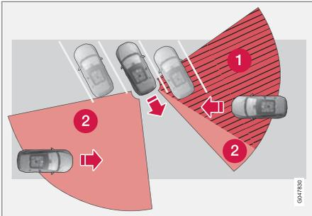
ในช่องจอดรถที่เป็นมุม CTA อาจ "มองไม่เห็นสิ่งใดเลย" ที่ด้านหนึ่งได้
