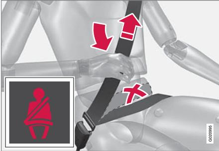
ยึดเข็มขัดคาดหน้าตักให้แน่นที่บริเวณเหนือตัก โดยการดึงเข็มขัดพาดไหล่ขึ้นไปทางหัวไหล่ เข็มขัดคาดหน้าตักจะต้องอยู่ที่ระดับต่ำ (ไม่อยู่เหนือช่วงท้อง)
