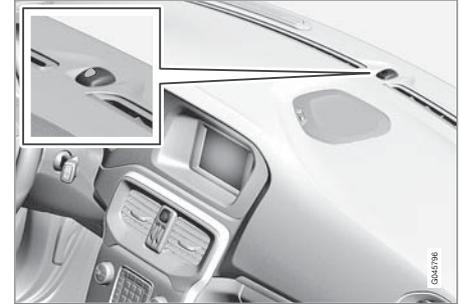
ไฟ LED หลอดเดียวกับไฟแสดงสัญญาณเตือน (น. 230)
