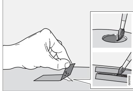
ก่อนทำการซ่อมสี จะต้องทำความสะอาดรถและปล่อยให้แห้ง และรถจะต้องอยู่ในที่ซึ่งมีอุณหภูมิสูงกว่า 15 °C
