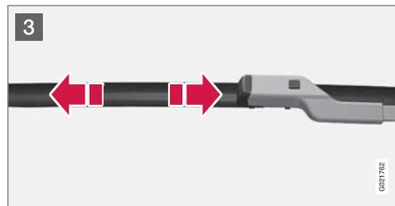
1. พับก้านที่ปัดน้ำฝนขึ้นเมื่ออยู่ในตำแหน่งบริการ กดปุ่มบนที่ยึดใบปัดน้ำฝน และดึงออกตรงๆ ขนานกับก้านปัดน้ำฝน
