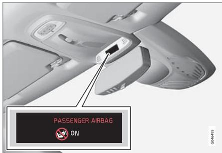
ไฟแสดงจะแสดงว่าถุงลมนิรภัยผู้โดยสารถูกกระตุ้น ข้อความและสัญลักษณ์เตือนในแผงคอนโซลที่หลังคาจะแสดงให้ทราบว่า ถุงลมนิรภัยสำหรับเบาะนั่งผู้โดยสารพร้อมทำงานแล้ว (ดูภาพประกอบก่อนหน้านี้)
