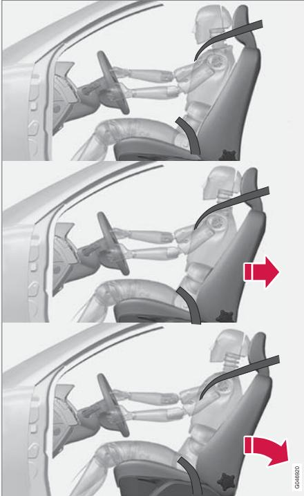
ระบบ WHIPS จะทำงานเมื่อเกิดการชนที่ด้านหลังรถ โดยขึ้นอยู่กับมุมและความเร็วของการชน และลักษณะของรถที่เข้ามาชน
