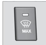
หลอดไฟในปุ่มที่ไล่ฝ้าจะสว่างขึ้นเมื่อการทำงานถูกกระตุ้น กดปุ่มซ้ำๆ เพื่อสั่งงานฟังก์ชันการทำงาน
