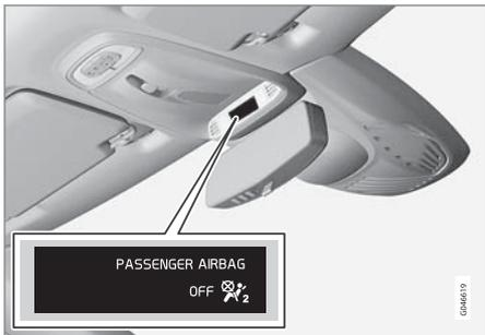
ไฟแสดงจะแสดงว่าถุงลมนิรภัยผู้โดยสารถูกเลิกการทำงาน ข้อความและสัญลักษณ์ในคอนโซลหลังคาจะแสดงให้ทราบว่า ถุงลมนิรภัยสำหรับเบาะนั่งผู้โดยสารด้านหน้าถูกเลิก (ดูภาพประกอบก่อนนี้)
