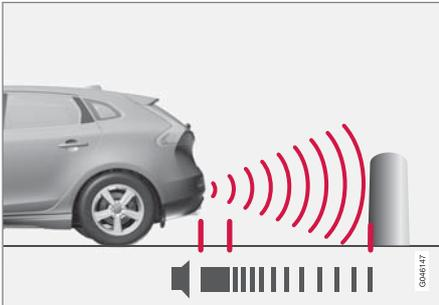
ระยะที่ครอบคลุมถึงทางด้านหลังของรถคือ ประมาณ 1.5 เมตร สัญญาณเสียงสำหรับสิ่งกีดขวางด้านหลังจะมาจากลำโพงตัวใดตัวหนึ่งที่อยู่ด้านหลัง
