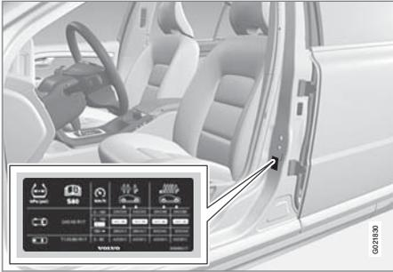
แผ่นป้ายระบุความดันลมยางที่เสาประตูด้านคนขับ (ระหว่างประตูด้านหน้ากับประตูด้านหลัง) จะแสดงความดันลมยางที่เหมาะสมสำหรับน้ำหนักบรรทุกและความเร็วต่างๆ ซึ่งข้อมูลเหล่านี้จะระบุไว้ในตารางความดันลมยางด้วย
