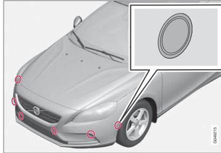
เซ็นเซอร์ PAP จะอยู่ในกันชน<sup>39</sup> โดยมี 6 ตัวที่ด้านหน้าและ 4 ตัวที่ด้านหลัง
