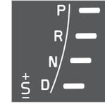
ตำแหน่งเกียร์อัตโนมัติจะแสดงขึ้นที่ด้านขวาของแผงหน้าปัดแบบรวม (เครื่องหมายจะติดสว่างขึ้นเพียงครั้งละหนึ่งเครื่องหมายเท่านั้น ซึ่งก็คือเครื่องหมายที่แสดงตำแหน่งคันเกียร์ในปัจจุบัน)
