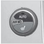
ฟังก์ชันอัตโนมัติจะทำการปรับอุณหภูมิ (น. 172), การปรับอากาศ (น. 173), ความเร็วของพัดลม (น. 171), การหมุนเวียนอากาศภายในรถ (น. 174) และ การกระจายอากาศ (น. 164) โดยอัตโนมัติ
