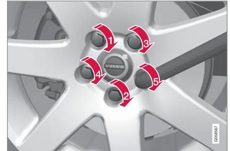
4. ชันแป้นเกลียวล้อตามแนวกากบาท สิ่งที่สำคัญก็คือ จะต้องขันน็อตล้อโดยใช้แรงบิดที่ถูกต้อง ตรวจสอบแรงบิดโดยใช้ประแจปอนด์
