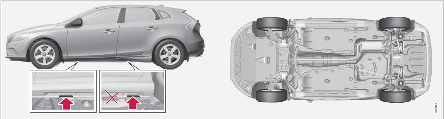
จุดขึ้นแม่แรง (ลูกศร) สำหรับแม่แรงที่ให้มาพร้อมกับรถยนต์ และจุดยกรถ (ที่ทำเครื่องหมายไว้ด้วยสีแดง)
