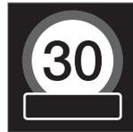
สัญลักษณ์สำหรับป้ายเพิ่มเติมซึ่งอยู่ในรูปของกรอบว่างได้สัญลักษณ์ความเร็วในแผงหน้าปัดแบบรวมหมายความว่า RSI ได้ตรวจพบป้ายเพิ่มเติมซึ่งมีข้อมูลเพิ่มเติมเกี่ยวกับการจำกัดความเร็วในขณะนั้น
