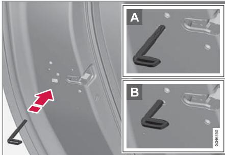
การล็อกประตูด้วยมือ อย่างสับสนกับล็อกนิรภัยสำหรับเด็ก (น. 228)
