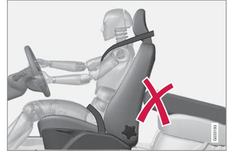
ห้ามวางวัตถุใดๆ ไว้บนเบาะนั่งด้านหลังที่อาจกีดขวางไม่ให้ระบบ WHIPS ทำงาน
