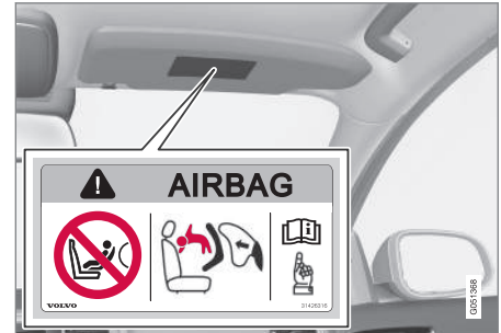
Alternativ 1: Placering av krockkuddens dekal på passagerarsidans solskydd.
