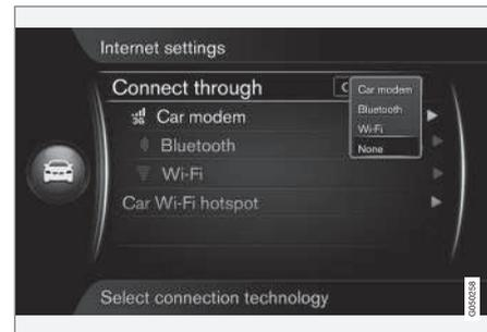
Pulse **OK/MENU** y seleccione **Ajustes → Configuración de Internet → Conectar a través de → Ninguno**. El automóvil no se conectará a Internet.
