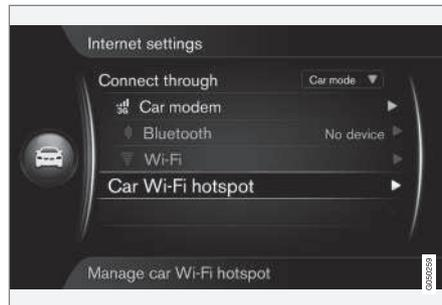
Cuando el automóvil está conectado a Internet a través del módem de vehículo, podrá compartirse la conexión a Internet (punto de acceso Wi-Fi) para que otras unidades usen del módem.
