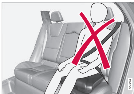
Placement incorrect, l'appui-tête doit être réglé à la même hauteur que la tête et la ceinture ne doit pas se trouver sous le niveau de l'épaule.
