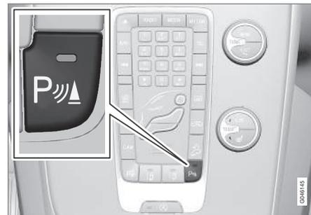
Lig/Desl dos sensores da Assistência ao estacionamento e do CTA<sup>37</sup>.
