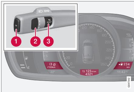
Podem ser exibidas em simultâneo três alternativas do computador de bordo - um em cada "janela".
