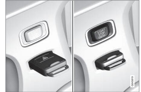
Interruptor de ignição com o comando à distância ejetado/inserido.
