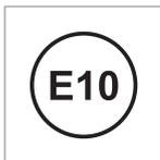
E10 é uma gasolina com um máximo de 3,7 % de oxigénio e um máximo de 10 vol % de etanol.
