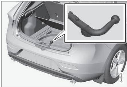
Quando não utilizado, o engate de reboque amovível deve ser guardado no bloco de espuma<sup>12</sup> sob o chão da carga.
