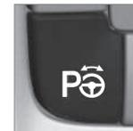
1. Ative o PAP pressionando este botão e conduza a uma velocidade inferior a 30 km/h (20 mph).
