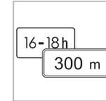
Algumas velocidades são válidas após, por exemplo, um determinado trajecto ou durante determinadas horas do dia. O condutor é alertado para estas condições com um símbolo de sinal adicional sob o símbolo com a velocidade.
