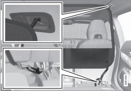
1. Engate os ganchos na fixação do teto com o trinco da correia de aperto virado para si.
