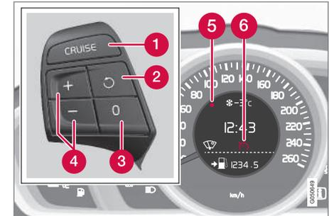
Teclado do volante e mostrador no automóvel **sem** Limitador de velocidade<sup>3</sup>.
