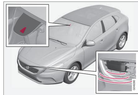
Sensor de radar e de câmara<sup>24</sup>.
