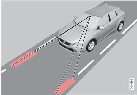
Uma câmara faz a leitura das linhas laterais pintadas na estrada/faixa de rodagem. Se o automóvel estiver na iminência de cruzar uma linha lateral a Assistência em fila actua na direcção para voltar a colocar o automóvel na faixa de rodagem com um ligeiro binário na direcção.
