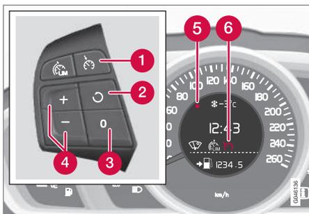
Teclado do volante e mostrador no automóvel **com** Limitador de velocidade<sup>3</sup>.
