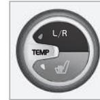
As temperaturas nos lados do condutor e do passageiro podem ser reguladas de modo independente. Pressione no botão **L/R** várias vezes para seleccionar o ajuste para a esquerda, direita, ou ambos os
