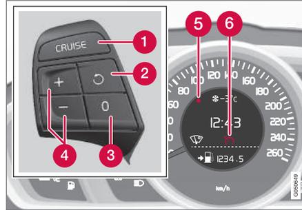
Teclado do volante e mostrador no automóvel **sem** Limitador de velocidade<sup>7</sup>.
