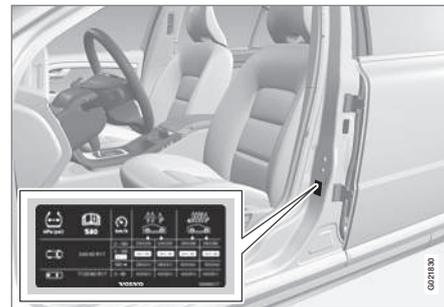
O autocolante da pressão dos pneus no pilar da porta do lado do condutor (entre a porta dianteira e traseira) indica as pressões correctas dos pneus para diferentes condições de carga e velocidades. Estas pressões também se encontram indicadas na tabela da pressão dos pneus.
