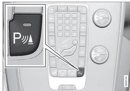
Lig/Desl dos sensores da Assistência ao estacionamento e do CTA.
