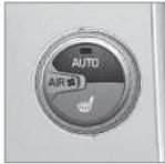
A função auto comanda automaticamente a temperatura (pág. 139), o ar condicionado (pág. 140), a velocidade do ventilador (pág. 138), a recirculação (pág. 141) e a distribuição de ar (pág. 133).
