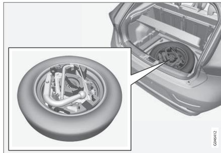
1. Levante a margem traseira do alçapão (em modelo com alçapão articulado, puxe a pega do alçapão, levante e desloque a parte traseira do alçapão para a frente).
