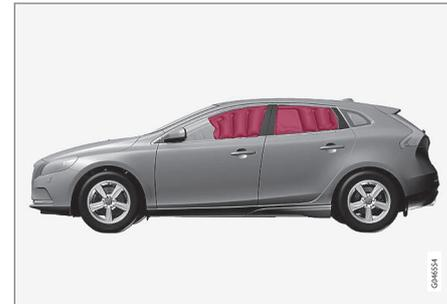
A cortina de colisão IC (Inflatable Curtain) é parte integrante do sistema SIPS (pág. 38). Esta encontra-se montada ao longo de ambos os lados do forro do tecto e ajuda a proteger o condutor e os passageiros nos lugares laterais do automóvel. Perante uma colisão suficientemente forte, os sensores reagem e a cortina de colisão é insuflada.
