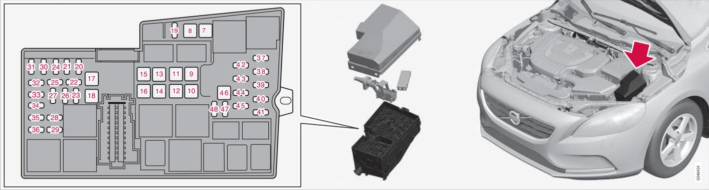
No interior da tampa existe um alicate que facilita a remoção e instalação de fusíveis no lugar.
