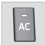
Quando a lâmpada no botão **AC** está acesa todo o ar condicionado do sistema é controlado automaticamente.
