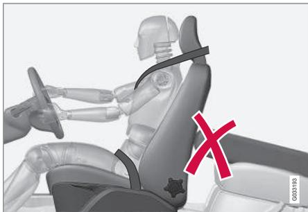
Não coloque qualquer objecto no banco traseiro que possa evitar o funcionamento do sistema WHIPS.
