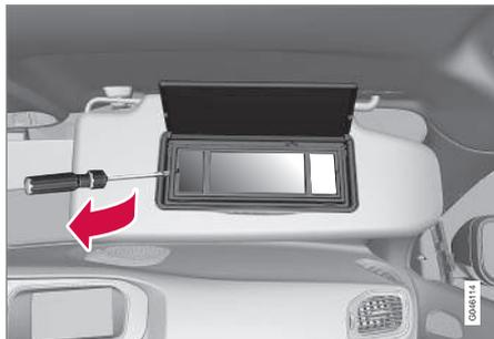
1. Introduza uma chave de fendas por baixo da lente da lâmpada e, com cuidado, levante o calço bloqueador exercendo força na extremidade.
