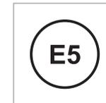
E5 é uma gasolina com um máximo de 2.7 % de oxigénio e um máximo de 5 vol % de etanol.
