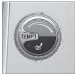
Pressione várias vezes no botão para mudar entre os diferentes níveis ou desligar a função.
