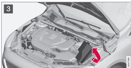
3 Desça a tampa na direcção do motor para aceder aos fusíveis.
