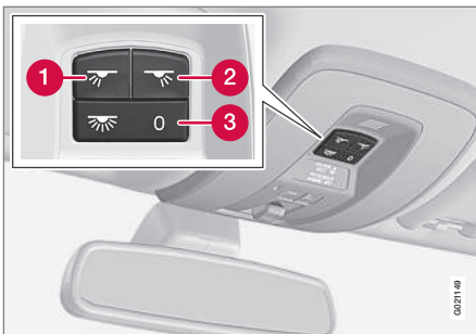
Interrupteurs d'éclairage, éclairage de pavillon avant
