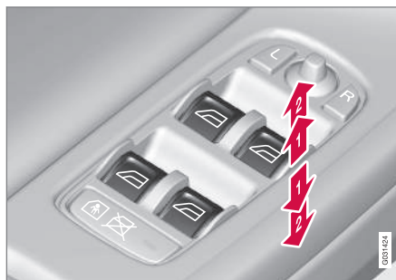
Fonctionnement des vitres électriques
