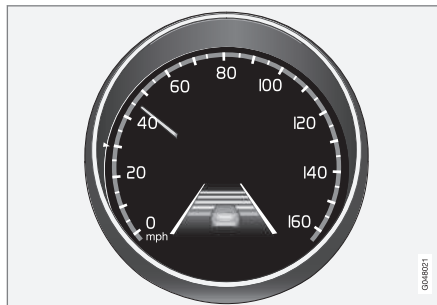
Avertissement de changement de voie (LDW) affiché dans le tableau de bord
