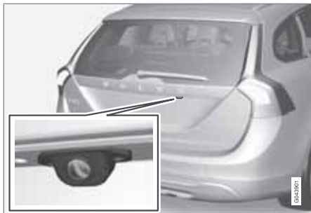
Posizione della telecamera accanto alla maniglia di apertura.
