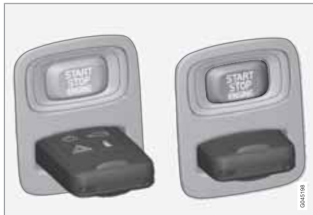
Blocchetto di accensione con chiave telecomando estratta/inserita.
