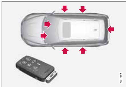
Punti di bloccaggio della chiave telecomando con stelo.
