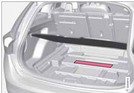
Vano per le cassette della rete protettiva.
