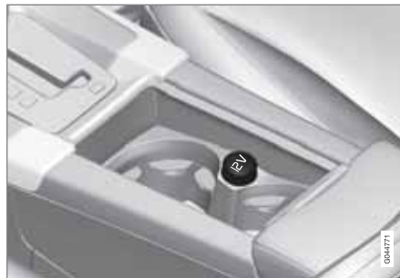
Presca da 12 V nel tunnel, sedile anteriore.
