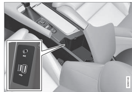
Port USB de la console de tunnel.
