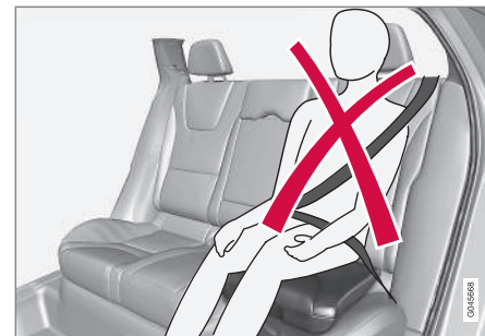
Helytelen elhelyezés, a biztonsági övet nem szabad a váll alatt elhelyezni.
