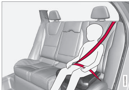
Megfelelő elhelyezés, a biztonsági övet a vállon kell elhelyezni.
