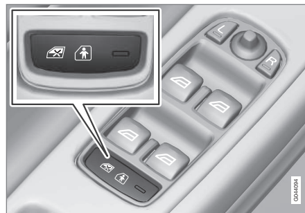
A vezetőajtó vezérlőpanelje.
