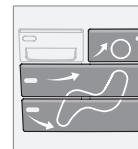
Appuyer sur l'un des trois boutons indiqués dans l'illustration pour activer le débit d'air sélectionné. Un symbole apparaissant à l'écran au-dessus du panneau de commande de la climatisation et la DEL allumée dans le bouton sélectionné indiquent que la fonction manuelle a été sélectionnée. Avec la circulation d'air sélectionnée manuellement, on peut choisir l'air chaud ou l'air frais. La température souhaitée est sélectionnée au moyen de la commande 9.
