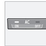
**ON** : Le système de climatisation est activé lorsque le témoin **ON** est allumé et il est commandé automatiquement pour maintenir la température sélectionnée.
