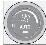
La fonction **AUTO** régule automatiquement la circulation d'air afin de maintenir la température désirée. La fonction automatique règle le chauffage, la circulation d'air, la vitesse du ventilateur, la recirculation et la distribution de l'air.
