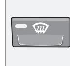
Pointe le débit d'air sur le pare-brise et les vitres latérales et augmente la vitesse du ventilateur. Lorsque le dégivreur est en marche :
