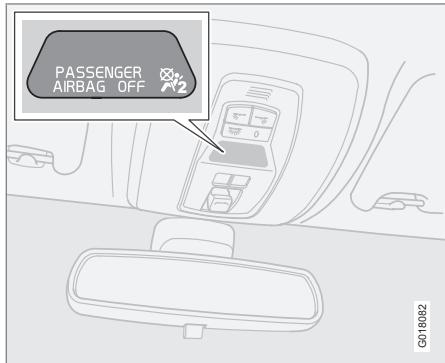
Témoin lumineux du capteur du poids de l'occupant (CPO)
