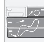
Appuyer sur l'un des trois boutons indiqués dans l'illustration pour activer le débit d'air sélectionné. Un symbole apparaissant à l'écran au-dessus du panneau de commande de la climatisation et la
