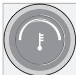
Le commutateur (avec le symbole du thermomètre) est utilisé pour sélectionner le refroidissement ou le chauffage, tant pour le côté du conducteur que pour celui du passager de la voiture.
