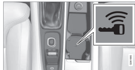
Umiejscowienie czytnika pomocniczego w konsoli między fotelami.
