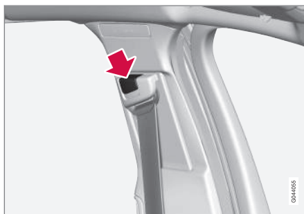
Impostazione dell'altezza della cintura di sicurezza. Premere il pulsante per impostare l'altezza della cintura. Posizionare la cintura più in alto possibile, senza che tocchi il collo.
