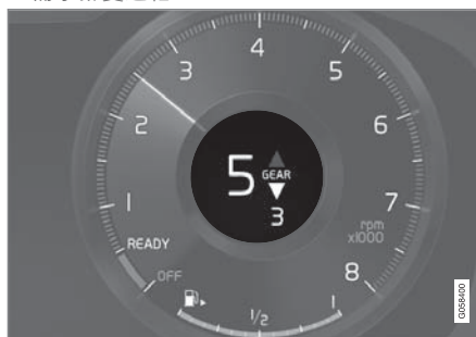
12 吋駕駛人顯示器*中的換檔指示器。
