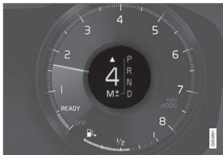
12 吋駕駛人顯示器*中的換檔指示器。
