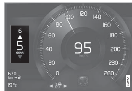
8 吋駕駛人顯示器中的換檔指示器。
