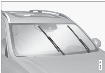
位於維修位置的雨刷片。
