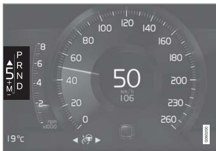
8 吋駕駛人顯示器中的換檔指示器。
