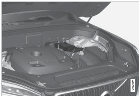
支援電瓶位於支撐桿旁的電瓶箱中。
