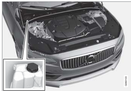
冷卻液膨脹水箱，左駕車。
