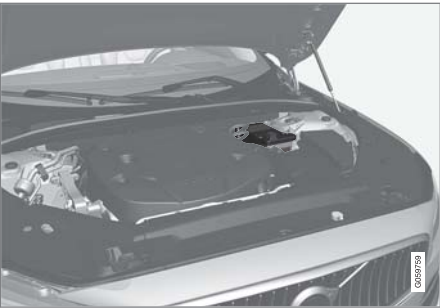
支援電瓶位於支撐桿旁的電瓶箱中。
