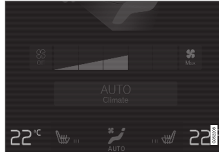
Boutons de température de la barre de climatisation.
