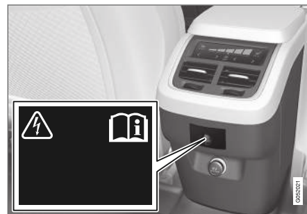
Prise électrique dans la console de tunnel de la seconde rangée de sièges.
