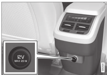
Prise 12 V dans la console de tunnel de la seconde rangée de sièges.
