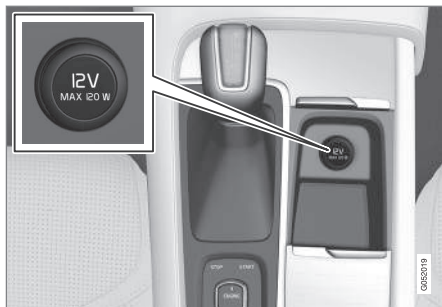
12 V strømuttak i tunnelkonsoll, forsete.
