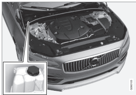
Ekspansjonsbeholder for kjølesystemet, bil med venstre ratt.
