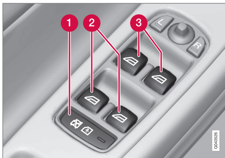
A vezetőajtó vezérlőpanelje.
