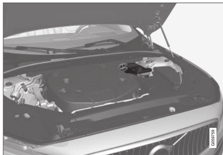
Apuakku sijaitsee laatikossa joustintukitornin vieressä.
