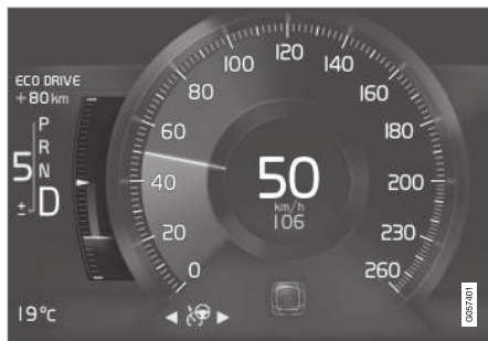
Eco-mittari 8-tuumaisessa kuljettajan näytössä.
