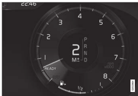
Kuljettajan näyttö vaihdettaessa ohjauspyörävalitsimilla käsinvaihteasennossa.
