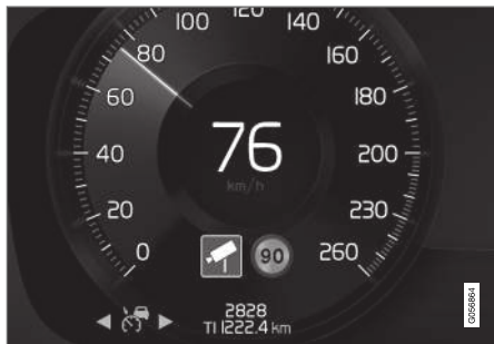
Nopeuskameratiedot kuljettajan näytössä 110 .
