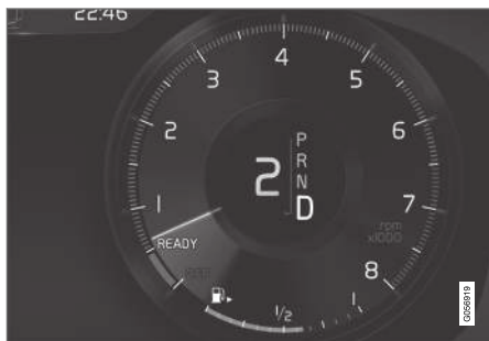
Kuljettajan näyttö vaihdettaessa ohjauspyörävalitsimilla.
