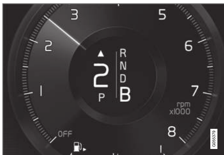
Schakelindicator op het bestuursdisplay 5 .
