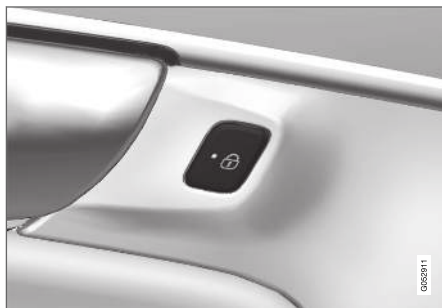
Knop voor vergrendelen in achterportier met led.
