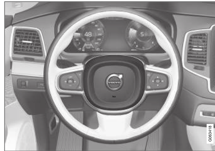
De claxon zit in het midden van het stuurwiel.
