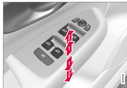
Bedieningsknoppen elektrisch bedienbare ruiten.
