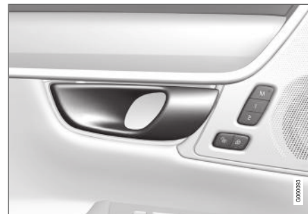
Openingsgreep voor alternatieve ontgrendeling op zijportier 11 .
