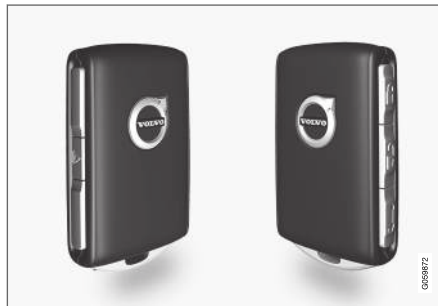
De transpondersleutel heeft vier knoppen – een aan de linker- en drie aan de rechterzijde.
