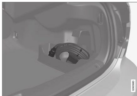
De laadkabel zit in het opbergvak rechts in de kofferbak.
