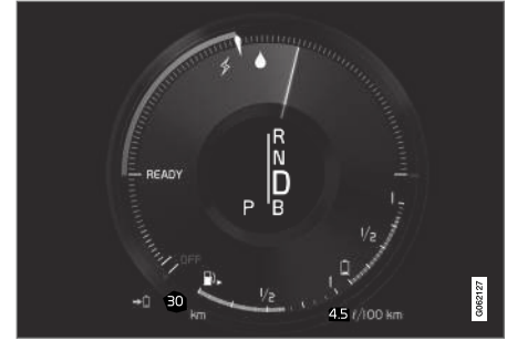
Bestuursdisplay bij aandrijving met elektromotor en verbrandingsmotor.
