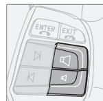
Le volume d'un appel est réglé avec les commandes au volant.
