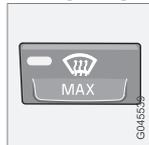
Pour dégivrer et désembuer rapidement le pare-brise avant et les vitres latérales. Le flux d'air est dirigé sur les vitres en utilisant une vitesse de ventilation élevée. La diode du bouton de dégivrage s'allume lorsque la fonction est connectée.
