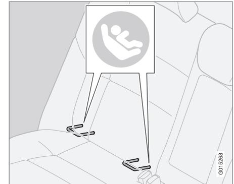
Les points de fixations du système ISOFIX sont dissimulés dans la partie inférieure du dossier de la banquette arrière, aux places extérieures.
