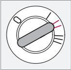
C'est la position de la télécommande en conduite. L'ensemble du système électrique est sous tension.
