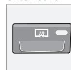
Ce bouton est utilisé pour dégivrer et désembuer rapidement la lunette arrière et les rétroviseurs extérieurs. Une pression sur le bouton active le chauffage simultané de la lunette arrière et des rétroviseurs. Une diode allumée sur le bouton indique que la fonction est activée.
