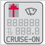
Pour l'aider, le conducteur dispose d'un indicateur qui lui indique le meilleur moment pour passer le rapport supérieur ou inférieur - GSI (Gear Shift Indicator).
