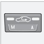
Cette fonction est sélectionnée pour isoler l'habitacle de l'air vicié extérieur, des gaz d'échappements etc. L'air est ainsi recyclé, c'est-à-dire qu'aucun air provenant de l'extérieur de la voiture n'entre
