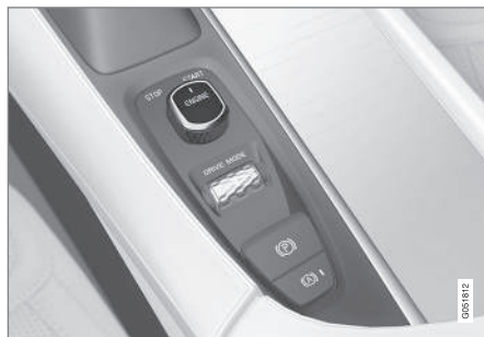
Käynnistyskytkin tunnelikonso- lissa.
