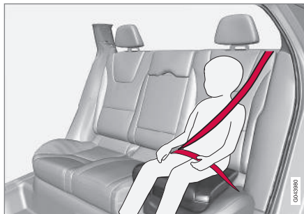
Korrekt placering. Selen skal være placeret inde på skulderen.
