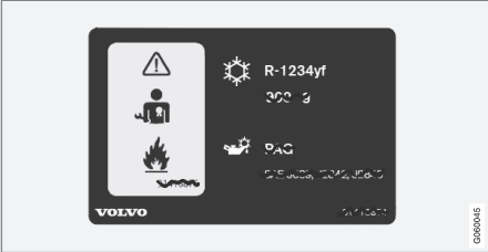
Mærkaten er placeret på indersiden af motorhjælmen.
