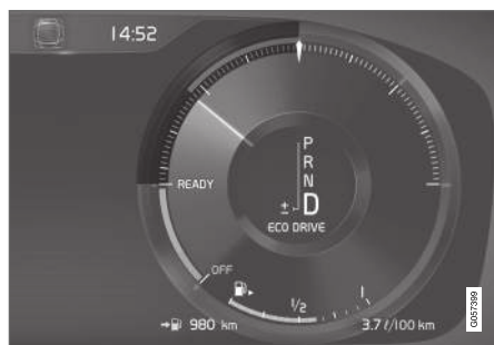
Eco műszer a 12-hüvelykes járművezetői kijelzőn*.
