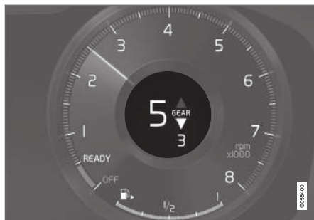
Fokozatváltás-jelző a 12-hüvelykes járművezetői kijelzőn*.
