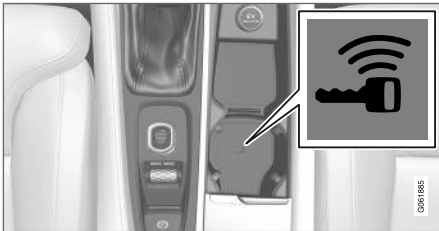
Atsarginės skaityklės vieta tunelio valdymo pulte.
