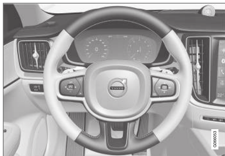
Garso signalo valdymo elementas įrengtas vairo viduryje.
