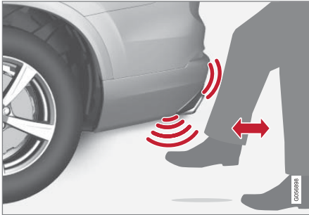
การเคลื่อนเท้าโดยการเตะภายในบริเวณการสั่งงานของตัวตรวจจับ
