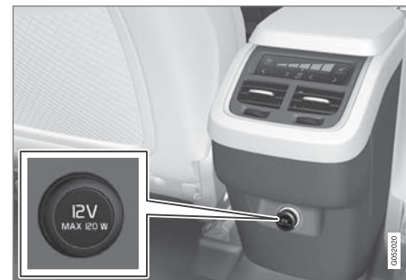
ปลั๊กไฟ 12 โวลต์ที่คอนโซลบริเวณโพงเพลากลาง, ที่นั่งแถวที่สอง
