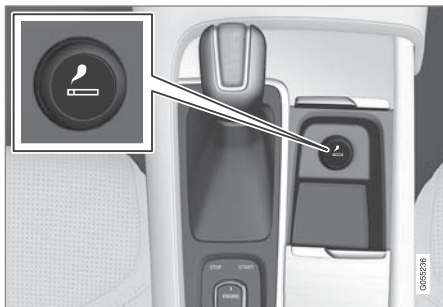
ที่จุดบุหรี่ในคอนโซลบริเวณโพรงเพลากลาง, ที่นั่งด้านหน้า
