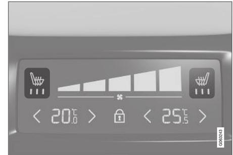
Commandes de chauffage de siège et lampes indicatrices sur l'arrière de la console de tunnel.
