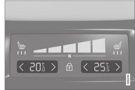
Commandes de température du panneau de climatisation arrière de la console de tunnel.
