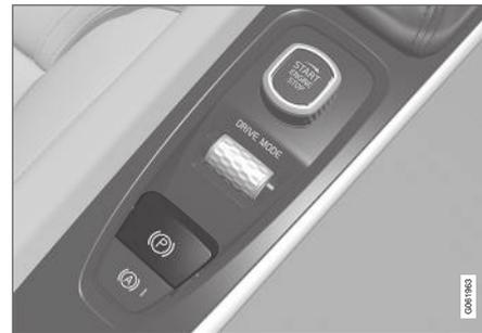
Les commandes de frein de stationnement se trouvent dans la console de tunnel, entre les sièges.
