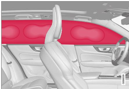
Les rideaux gonflables sont montés sur les deux côtés de la garniture de pavillon et contribuent à protéger le conducteur et les passagers des sièges extérieurs de la voiture. **IC AIRBAG** est gravé sur les panneaux.
