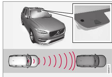
La caméra/le capteur radar mesurent la distance par rapport au véhicule qui précède.
