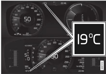
Emplacement de la jauge de température extérieure dans l'écran du conducteur de 12 pouces\* et de 8 pouces.
