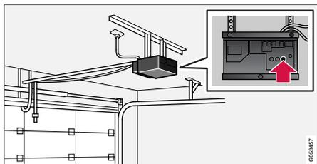
4. Localiser le bouton de formation<sup>18</sup> sur le récepteur pour par exemple l'ouvre-porte de garage. Il se trouve habituellement près du support d'antenne sur le récepteur.
