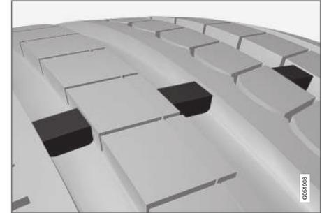
L'indicateur d'usure de sculpture est une bande étroite relevée traversant les sculptures longitudinales du pneu. Les lettres TWI (Tread Wear Indicator) sont visibles sur le flanc du pneu. Lorsqu'il reste environ 1,6 mm (1/16 pouce) sur la sculpture, la sculpture est à la même hauteur que l'indicateur d'usure de sculpture. Remplacer le pneu dès que possible. Lorsque la sculpture du pneu est basse, l'adhérence se réduit beaucoup sous la pluie ou dans la neige.
