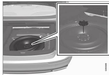
La roue de secours se trouve dans l'espace de roue de secours avec l'extérieur de la roue dirigée vers le bas. Le bloc de mousse contient tous les outils nécessaires pour remplacer une roue.
