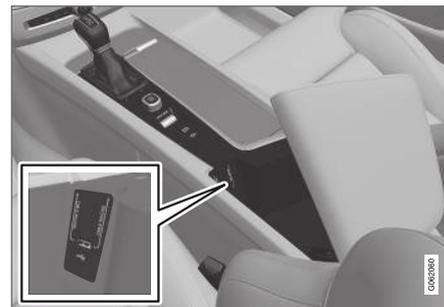
Ports USB (type A) dans la console centrale. Acheminer le câble vers l'avant pour contribuer à éviter le pincement lorsque le recouvrement est fermé.
