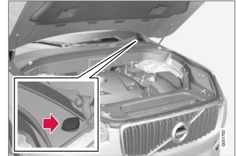
Le liquide lave-glace est versé dans le réservoir dont le bouchon est bleu. Le réservoir est utilisé pour le lave-glace de pare-brise et le lave-phare\*
