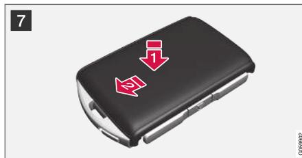
**7** **1** Replacer le couvercle arrière et l'enfoncer jusqu'au déclic.
