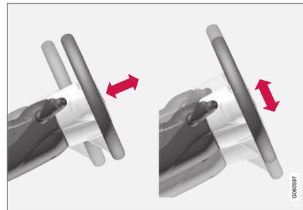
Le volant peut être réglé en hauteur et en profondeur.
