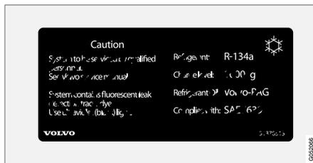
**6** **Autocollant de climatisation** fluide frigorigène R134a.
