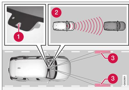
Le capteur de caméra/radar surveille la distance par rapport au véhicule qui précède et détecte les marquages de voie.
