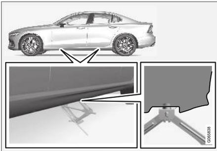
9. Placer le cric sous le point de fixation utilisé, en vérifiant si le sol est ferme, horizontal et non glissant.
