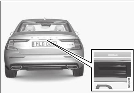
Le couvercle du coffre est maintenu fermé par un mécanisme électronique de verrouillage.
