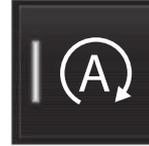
Pour désactiver le démarrage/arrêt, effleurer le bouton de fonction **Marche/Arrêt** de la vue Fonctions dans l'écran central. La lampe indicatrice du bouton s'éteint lorsque la fonction a été désactivée.
