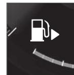
Dans l'écran du conducteur, une flèche à côté du symbole de pompe à carburant indique le côté du véhicule sur lequel se trouve le volet du réservoir de carburant.
