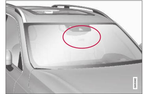
Emplacement du capteur radar.
