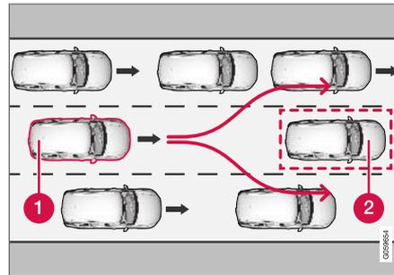
Votre véhicule (1) ne peut détecter toutes les routes d'échappement potentielles pour s'écarter du véhicule à l'avant (2) et peut dès lors appliquer les freins prématurément.
