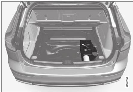
Le bloc de mousse placé sous le plancher du compartiment de chargement contient l'œillet de remorquage, le système d'étanchéité de pneu, l'outil de dépose des enjoliveurs de plastique de boulons de roue et l'outil de dépose des boulons de verrouillage de roue.
