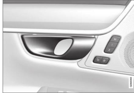
Méthode alternative de déverrouillage en utilisant la poignée d'ouverture de porte latérale<sup>11</sup>.
