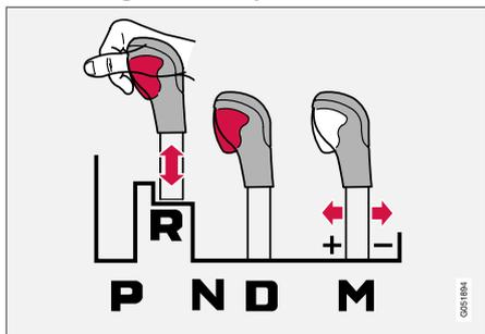
Le sélecteur de rapport peut être déplacé d'avant en arrière entre **N** et **D**. Les autres positions possèdent un verrou qui est commandé en utilisant le bouton de verrouillage du sélecteur de vitesses.
