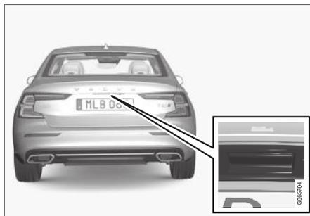
La plaque de pression caoutchoutée du capot de coffre peut être utilisée pour le déverrouillage.
