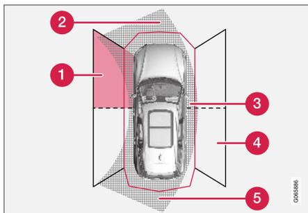
Secteurs des capteurs d'aide au stationnement où les obstacles peuvent être détectés.
