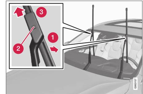
1. Lever les bras d'essuie-glace en position d'entretien. La position d'entretien est activée/désactivée via la vue Fonctions de l'écran central lorsque la voiture est arrêtée et que l'essuie-glace du pare-brise ne fonctionne pas.
