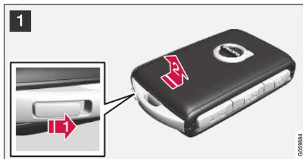
**1** ➔ Tenir la clé de commande à distance avec le côté avant (avec le logo Volvo) dirigé vers le haut et déplacer le bouton de la section de bague de clé vers la droite. Faites glisser le couvercle avant légèrement vers le haut.
