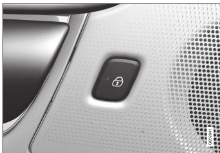
Knop voor vergrendelen in achterportier met led.
