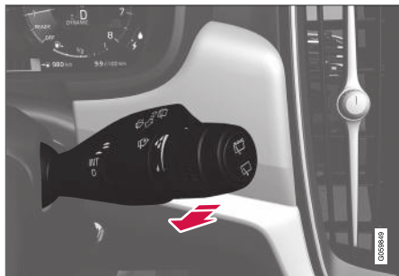
Sproeifunctie, rechter stuurhendel.
