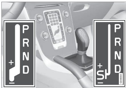
D: automatisch schakelen. +/-: handmatig schakelen. S: Sport-stand*. 7
