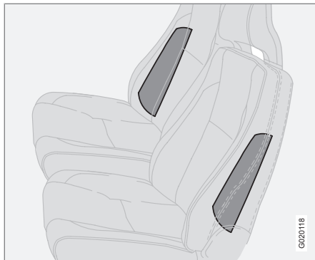
Emplacement des coussins gonflables latéraux.
