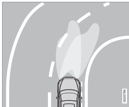
Faisceau d'éclairage avec la fonction désactivée (gauche) ou activée (droit).
