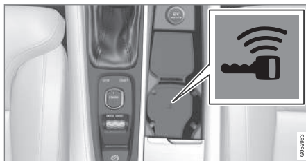
Positie back-uplezer in de tunnelconsole.
