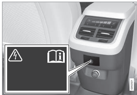
230V-aansluiting in tunnelconsole, tweede zitrij.
