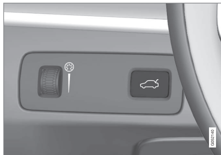
Knop voor het openen/sluiten op het dashboard.
