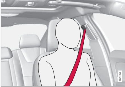
حزام الأمان مُركب بشكل صحيح.
