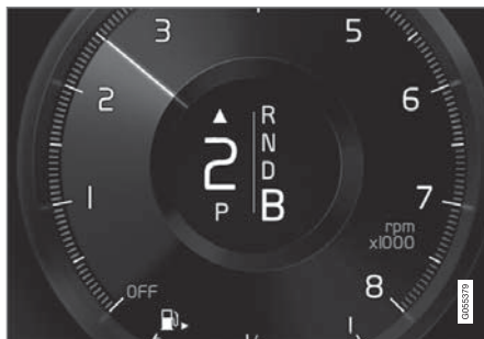
駕駛人顯示器中的換檔指示器 3 。
