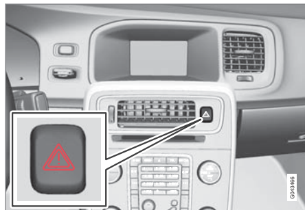
非常点滅灯ボタン
