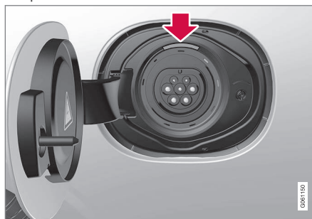
Localização da lâmpada de LED na tomada de entrada de carregamento do veículo.
