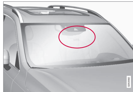
Localização da unidade do radar.
