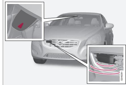
Kamera- und Radarsensor<sup>18</sup>.
