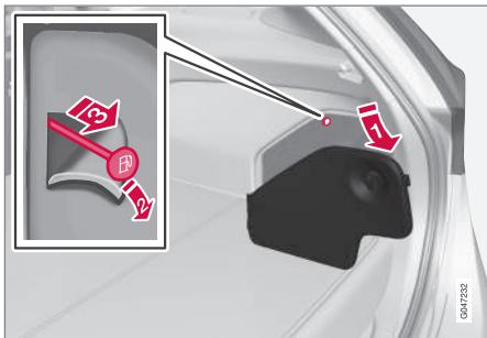
1. Die Seitenklappe im Laderaum öffnen/entfernen (auf derselben Seite wie die Kraftstofftankklappe).
