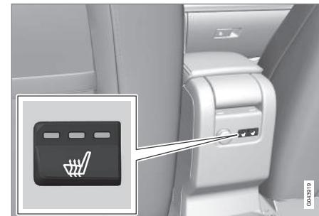
Die aktuelle Heizleistung wird in den Lampen der Druckschalter angezeigt.
