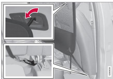
4. Befestigen Sie die Haken beidseitig in den Ösen an den Sitzschienen, drücken Sie die Sperrnase nach unten und spannen Sie den Gurt.
