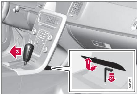
Wenn das Fahrzeug nicht gefahren werden kann, z. B. wenn die Batterie entladen ist, muss der Wählhebel aus der P-Stellung bewegt werden, damit das Fahrzeug bewegen werden kann.
