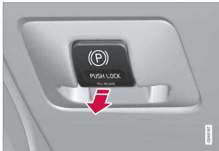
Feststellbremsregler - lösen.
