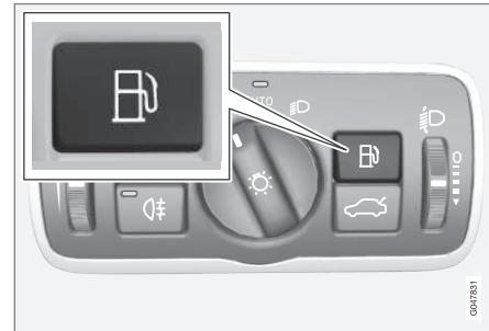
Die Kraftstofftankklappe mit der Taste am Schalterfeld Beleuchtung öffnen – die Klappe öffnet sich, sobald die Taste losgelassen wird.
