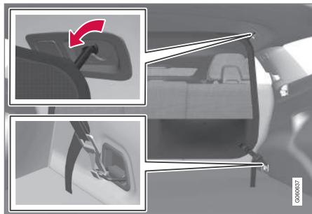
3. Hängen Sie die Haken der Ladesicherung beidseitig ein, drücken Sie die Sperrnase nach unten und spannen Sie den Gurt.
