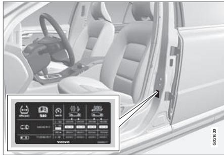
Das Schild für den Reifendruck am Türrahmen der Fahrerseite (zwischen Vorder- und Fondtür) zeigt den Reifendruck für die für das Fahrzeug empfohlenen Reifengrößen. Der Reifendruck ist außerdem in der Reifendrucktabelle angegeben, siehe Reifen - zugelassener Reifendruck (S. 447).
