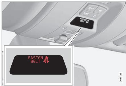
Das akustische Signal ist geschwindigkeitsabhängig und in bestimmten Fällen zeitabhängig. Das optische Signal befindet sich in der Dachkonsole und im Kombinationsinstrument (S. 70).
