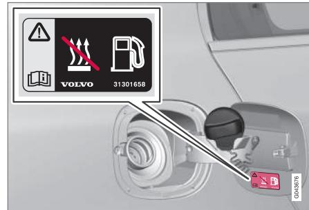
Der Tankverschluss kann an der Klappe aufgehängt werden.
