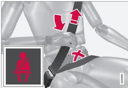
Den Beckengurt über der Hüfte spannen. Dazu den Schulergurt nach oben zur Schulter ziehen. Der Beckengurt muss niedrig anliegen (d. h., er darf nicht über dem Bauch liegen).
