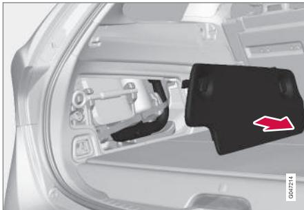
3. Den Wagenheber\*, das Werkzeug zum Abnehmen der Kunststoffkappen von den Radmuttern und den Radmutternschlüssel\* (in einem Beutel auf dem Kofferraumboden) zurechtlegen. Wenn ein anderer Wagenheber gewählt wird, siehe Fahrzeug aufbocken (S. 377).
