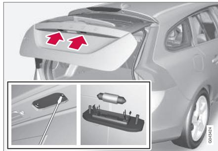
1. Die Schrauben mit einem Schraubendreher lösen.
