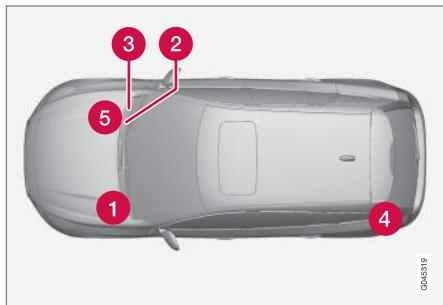
Position der Zentralelektriken in Fahrzeugen mit Linkssenkung, bei Rechtslenkung wechseln die Zentralelektriken unter dem Handschuhfach die Seite.
