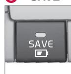
Diese Funktion startet das Aufladen der Hybridbatterie und sorgt dafür, dass deren Ladestand eine Kapazität nicht unterschreitet, die einer Fahrstrecke von ca. 20 km im Elektrobetrieb entspricht. Dadurch soll die Energie für spätere Gelegenheiten gespart werden, in denen der Elektrobetrieb angebracht ist, z. B. beim Fahren in der Stadt.
