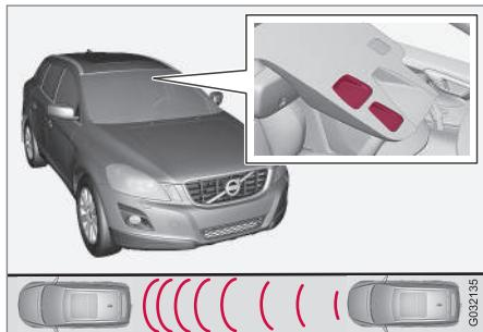
Sender- und Empfängerfenster des Lasersensors<sup>11</sup>.
