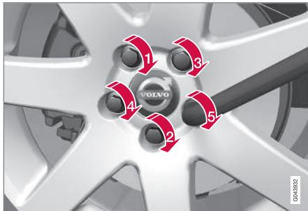
4. Die Radschrauben über Kreuz festziehen. Es ist wichtig, dass die Radschrauben ordentlich festgezogen werden. Mit 140 Nm festziehen. Anzugsdrehmoment mit einem Drehmomentschlüssel überprüfen.
