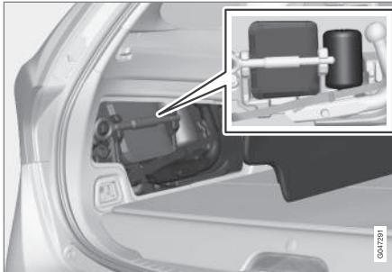
Die Lampen werden zugänglich, indem der Reifenabdichtsatz herausgenommen wird.
