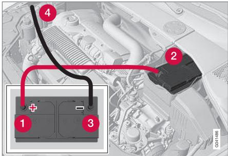
Wenn eine andere Batterie zur Starthilfe verwendet wird, werden folgende Schritte empfohlen, um einen Kurzschluss oder andere Schäden zu vermeiden:
