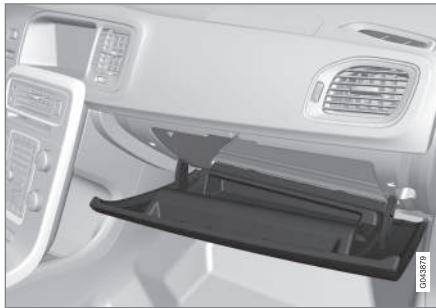
Hier können beispielsweise die Betriebsanleitung des Fahrzeugs und Straßenkarten aufbewahrt werden. Auf der Innenseite der Klappe ist ein Halter für Stifte vorhanden. Das Handschuhfach kann verriegelt\* (S. 188) werden, indem das Schlüsselblatt (S. 176) verwendet wird.
