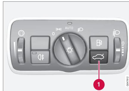
① Entriegelung der Heckklappe
