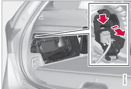
Die Lampen der Rückfahrsscheinwerfer, Nebelschlussleuchte und des Blinkers in der Heckleuchte werden vom Kofferraum aus gewechselt.
