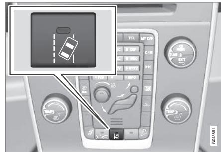
Auf die Taste in der Mittelkonsole drücken, um die Funktion ein- bzw. auszuschalten. Die Taste leuchtet wenn die Funktion eingeschaltet ist.
