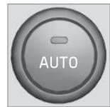
Bei Auswahl von einer oder mehreren manuellen Funktionen werden die übrigen Funktionen weiterhin automatisch gesteuert. Durch Drücken auf **AUTO** werden sämtliche manuellen Einstellungen ausgeschaltet. Auf dem Bildschirm erscheint **AUTO-KLIMA**.
