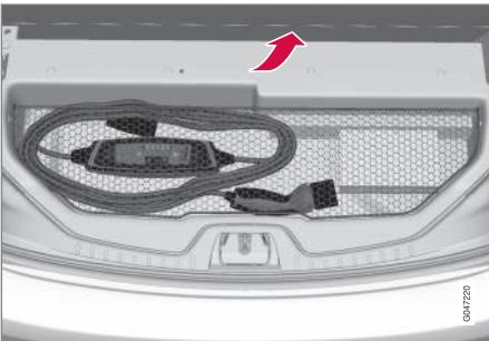
Das Ladekabel befindet sich in einem Staufach unter der Bodenklappe im Kofferraum.
