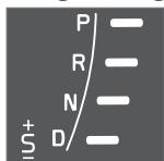
Automatische Gangstellungen werden rechts auf dem Kombinationsinstrument angezeigt (jeweils nur eine Markierung leuchtet - die für die aktuelle Wählhebelstellung.)
