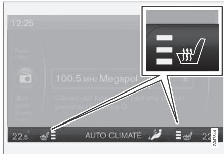
Die aktuelle Heizleistung wird im Bildschirm der Mittelkonsole angezeigt.
