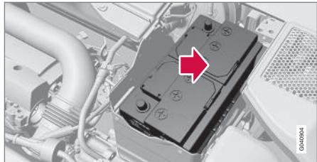
1. Die Batterie in den Batteriekasten stellen.
