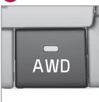
Betrieb aktiviert den Allradantrieb, der die Straßenlage und Traktion verbessert. Der Modus ist vor allem für niedrige Geschwindigkeiten bei glatter Straßenlage vorgesehen, aber der Allradantrieb kann auch bei schnellerer Fahrt stabilisierend wirken.
