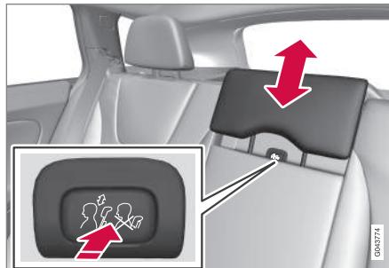
Die Kopfstütze an die Körpergröße des Insassen anpassen, so dass sie möglichst den ganzen Hinterkopf abdeckt. Die Kopfstütze je nach Wunsch nach oben schieben.
