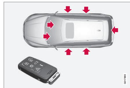
Verriegelungspunkte für Transponderschlüssel mit Schlüsselblatt.
