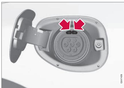
Die LED-Leuchten zeigen den aktuellen Status während der Aufladung. Die weiße, blaue, rote und gelbe Lampe wird aktiviert, wenn die Innenraumbeleuchtung eingeschaltet wird - das Leuchten wird noch eine kurze Zeit fortgesetzt,
