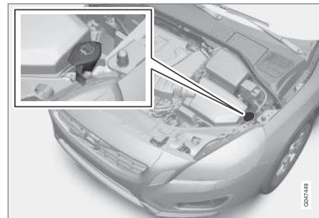
Die Nachfüllung von Scheibenreinigungsflüssigkeit erfolgt durch den Einfüllstutzen mit dem blauen Deckel.
