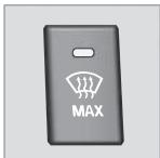
Luft strömt zu den Scheiben. Die Lampe in der Entfroster-taste leuchtet, wenn die Funk-tion eingeschaltet ist.
