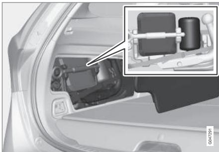
Die Abschleppöse, der provisorische Reifendichungssatz und das Werkzeug für die Kunststoffkappen der Radmuttern für das Fahrzeug befinden sich hinter der Abdeckung auf der linken Seite des Kofferraums. Hier gibt es auch Platz für die Hülse der abschließbaren Radschrauben.
