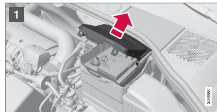
5. Die Clips an der vorderen Abdeckung der Fahrzeugschlüsselstellung öffnen **1** und die Abdeckung abnehmen.
