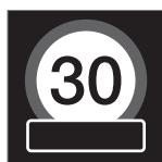
Bei Anzeige eines leeren Rahmens unter dem Geschwindigkeitssymbol im Kombinationsinstrument<sup>24</sup> hat das RSI ein Zusatzschild mit zusätzlichen Informationen zur aktuellen Geschwindigkeitsbegrenzung erfasst.
