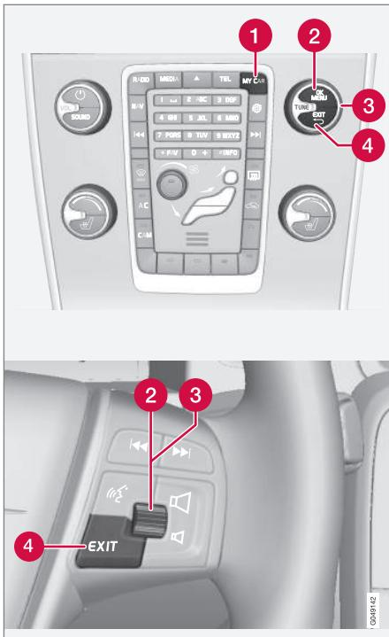
Bedienfeld in der Mittelkonsole und Tastenfeld am Lenkrad. Die Abbildung ist eine schematische Darstellung – je nach Ausstattung und Markt variieren Anzahl der Funktionen und Anordnung der Tasten.
