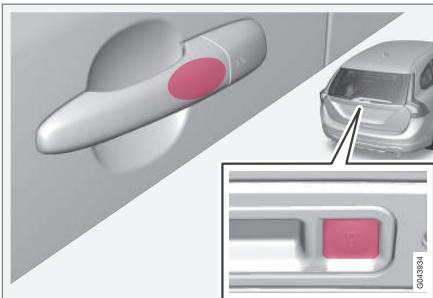
Der berührungsempfindliche Bereich am Außentürgriff der Türen sowie die gummierte Taste neben der gummierten Druckplatte der Heckklappe.
