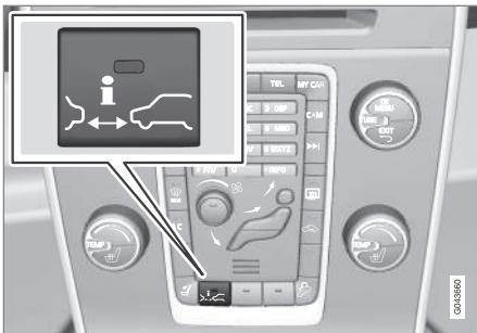
Auf die Taste in der Mittelkonsole drücken, um die Funktion ein- bzw. auszuschalten. Die leuchtende Lampe in der Taste zeigt an, dass die Funktion eingeschaltet ist.
