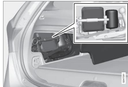
Der Abdichtungssatz befindet sich hinter der Abdeckung auf der linken Seite des Kofferraums.
