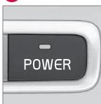
Diese Option versetzt das Fahrzeug in den Zustand, in dem das beste Ansprech- und Leistungsverhalten geliefert wird, indem sowohl der Elektro- als auch der Verbrennungsmotor dauernd aktiv sind. Das Fahrzeug fährt sich sportlicher und reagiert beim Gasgeben durch schnelleres Ansprechen.
