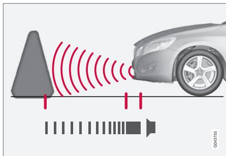
Der Messbereich in gerader Richtung vor dem Fahrzeug liegt bei ca. 0,8 m. Das Tonsignal für Hindernisse vor dem Fahrzeug kommt aus einem der vorderen Lautsprecher.
