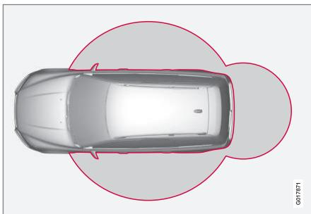
Die grauen Kreise in der obenstehenden Abbildung illustrieren den Bereich, der von den Antennen des Systems abgedeckt ist.
