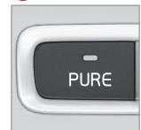
Diese Alternative zielt auf den Elektroantrieb sowie einen möglichst niedrigen Energieverbrauch ab und hilft dem Fahrer, die maximale Leistung aus der Hybridbatterie zu holen.
