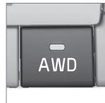
Mit dieser Taste in der Mittelkonsole wird der Allradantrieb (AWD – All Wheel Drive) aktiviert, siehe Antriebssystem - Antriebsmodi (S. 282). Der Modus ist in erster Linie für den Einsatz bei geringer
