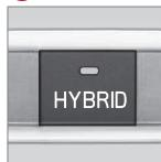
Diese Option ist der voreingestellte Antriebsmodus für den Start. Das Steuersystem verwendet sowohl den Elektro- als auch den Verbrennungsmotor - einzeln oder zusammen - und berechnet deren optimalen Einsatz hinsichtlich Leistung, Kraftstoffverbrauch und Komfort.
