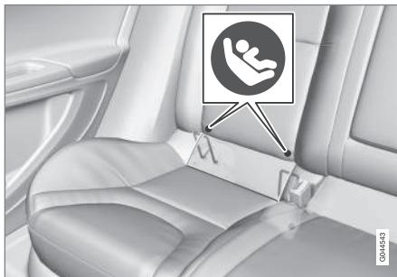
Die Befestigungspunkte für das ISOFIX-Befestigungssystem sind hinter dem unteren Teil der Rückenlehne im Fond, in den äußeren Sitzplätzen, verborgen.
