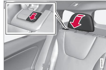
Am Sperrgriff, der sich am nächsten an der Kopfstütze befindet, ziehen, um die Kopfstütze vorzuklappen.
