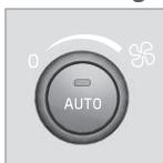
Mit dem Drehregler wird die Gebläsegeschwindigkeit erhöht oder gesenkt. Bei der Wahl von **AUTO** wird die Gebläsegeschwindigkeit automatisch (S. 138) geregelt – die zuvor eingestellte Gebläsegeschwindigkeit wird außer Acht gelassen.
