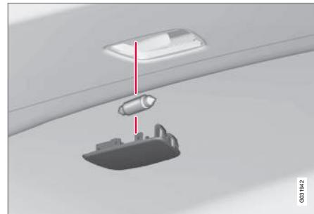
1. Vorsichtig einen Schraubendreher in das Lampengehäuse einführen und vorsichtig abheben, um das Lampengehäuse zu lösen.
