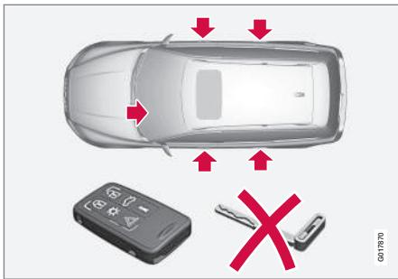
Verriegelpunkte für Transponderschlüssel ohne Schlüsselblatt und **aktivierter** Geheimverriegelung.
