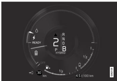
Juhiekraanil näidatakse elektrimootoriga pidurduse ajal toimuvat laadimist.
