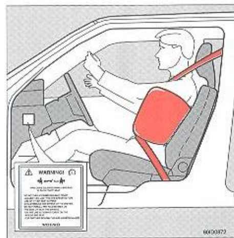
Opblazen van de SIPS-airbag
