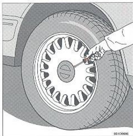
Wieldop verwijderen (aluminium velg)
