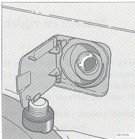
Vulpijp met vernauwing voor auto's met katalysator
