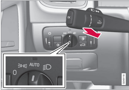
Stuurhendel en verlichtingsdraaiknop in stand AUTO .
