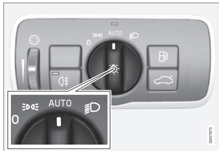
Verlichtingsdraaiknop in stand AUTO .
