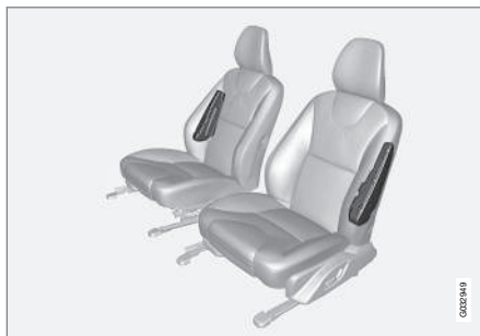
Coussin gonflable SIPS du côté conducteur
