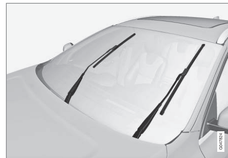
Balais d'essuie-glace en position d'entretien
